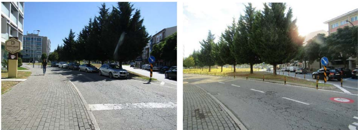
Figura 13 - Pilaretes inibem o estacionamento abusivo na zona BUILD (antes e depois da intervenção) Fonte: Ribeiro et al. (2019b)
