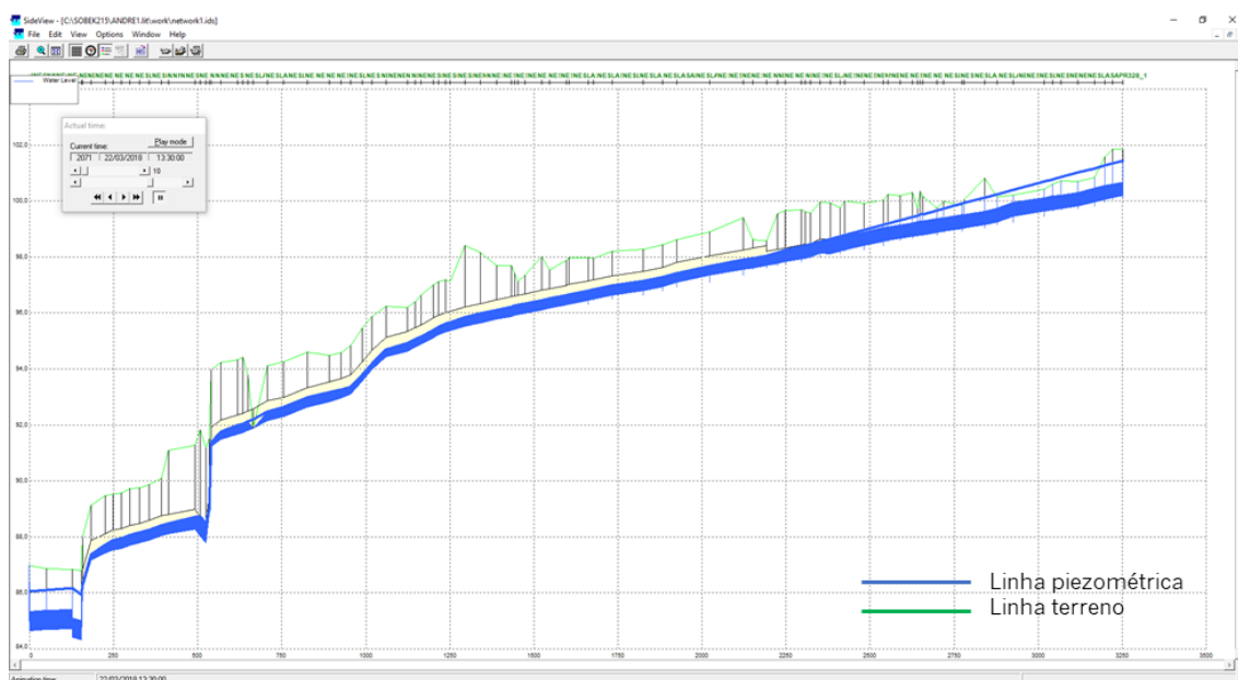
Figura 32 – Perfil de escoamento no interceptor de Vizela (FD4) para o período de 1 a 31 de março de 2018.
