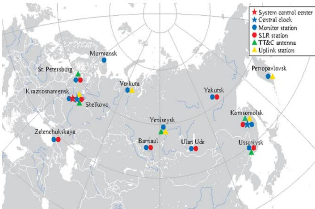
Figura 26 - Segmento de Controle GLONASS [74]
