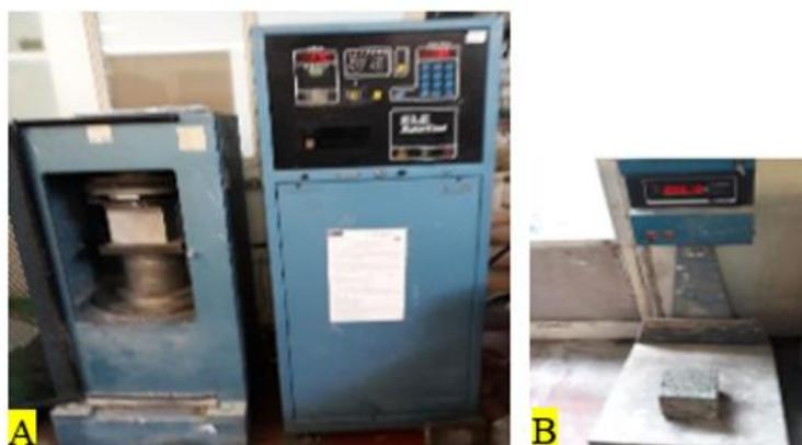
Figura 3. 14 Máquina da Resistência à Compressão (A), e balança (B)
