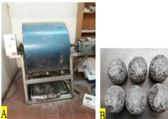
Figura 3. 18 Máquina de Los Angeles (A) [77] e os provetes ensaiados (B)
