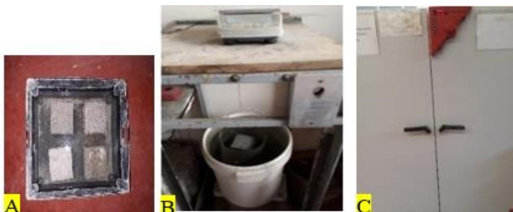
Figura 3.11 Provetes e equipamentos de ensaios de absorção de água por imersão [69] [70]
