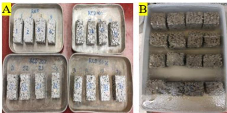
Figura 3. 19 Provete no início (A), e recipiente com provete imerso no sulfato magnésio (B)
