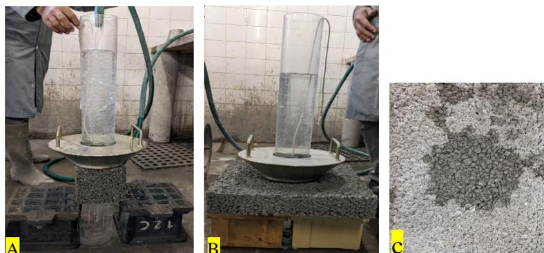
Figura 4. 14 Ensaio de permeabilidade LCS em cubos (A) e lajetas (B) e (C) resultado
