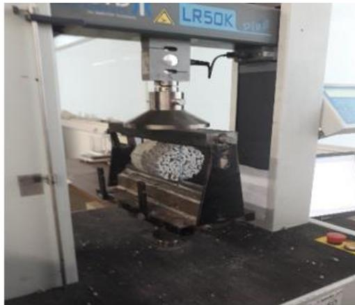
Figura 3. 15 Ensaio de resistência à tração
