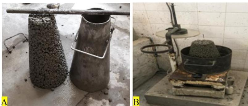
Figura 4.1 A) Ensaio de abaixamento, B) Ensaio de vêbê
