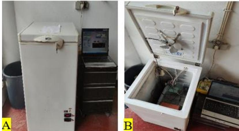
Figura 3. 20 Equipamentos (A) e colocação dos provetes de gelo degelo (B)
