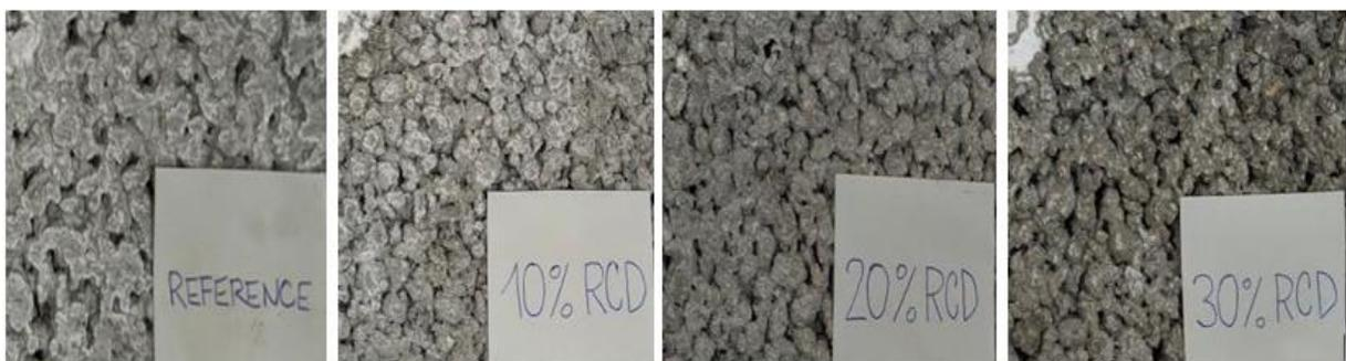
Figura 3. 21 As características dos quatro provetes de Referência e betão de RCD
