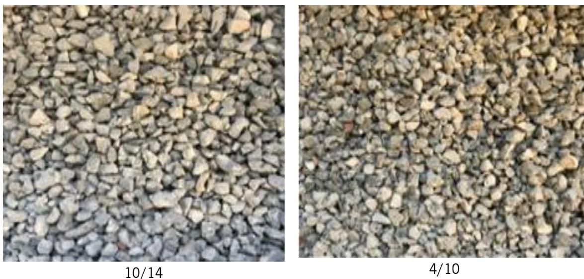
Figura 2. 11 Agregado reciclado de peças pré-moldadas de betão
