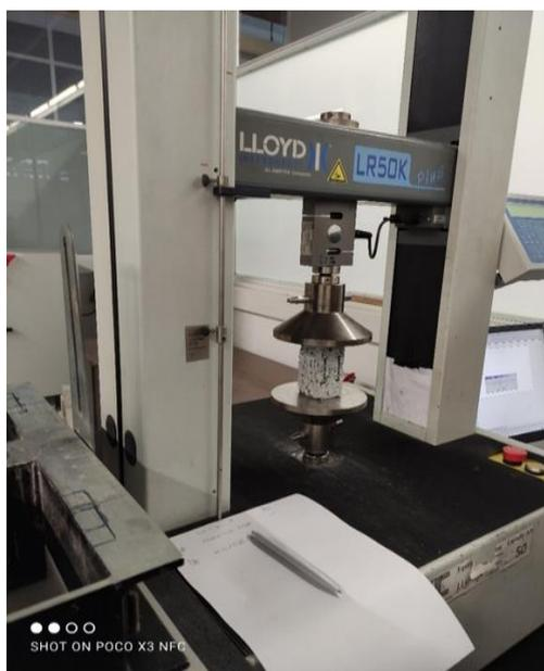
Figura 3. 17 Ensaio de módulo de elasticidade
