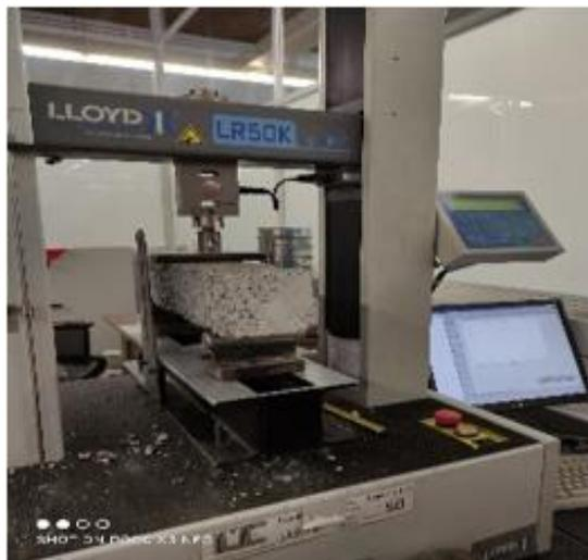
Figura 3. 16 Máquina do ensaio de resistência à flexão
