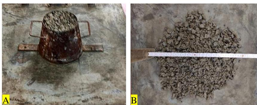
Figura 4.2 Equipamento (A) e medição do espalhamento (B)
