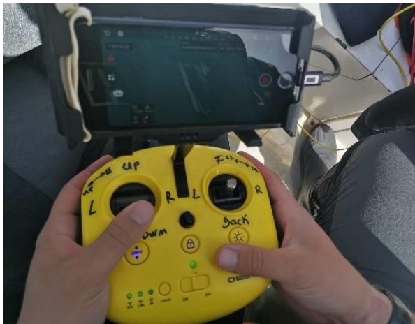
Figura 4.4.: Fotografias do ROV. A) ROV visto de cima com cabo de segurança colocado; B) Frente do ROV com duas lanternas laterais, uma no topo e a câmara GoPro; C) Bobine com o cabo de 200 m do equipamento; D) Comando de controlo do ROV ligado ao telemóvel onde se visualiza em tempo real e se pode alterar as definições além de começar/parar gravações.
