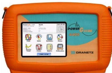
Figura 2.9 - Monitorizador de qualidade de energia Dranetz Power Guide 4400 (Fonte: Dranetz) [52].
