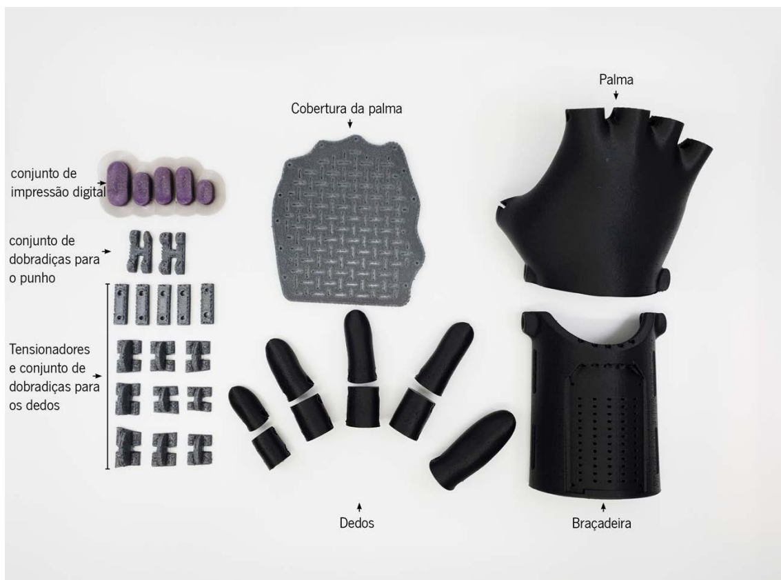
Figura 32. Peças impressas em 3D que darão origem à prótese mecânica de membro superior.
