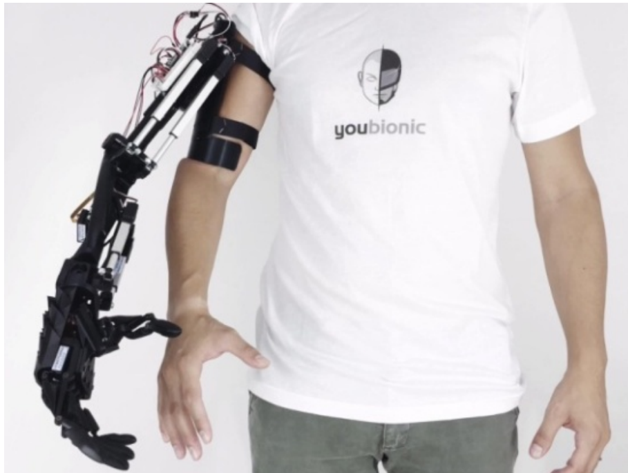
Figura 18. Fotografias da You bionic hand, mão biônica com suporte vestível para braço, 6 atuadores ativos, e impressa em PLA, (Ciccarese, 2018).
