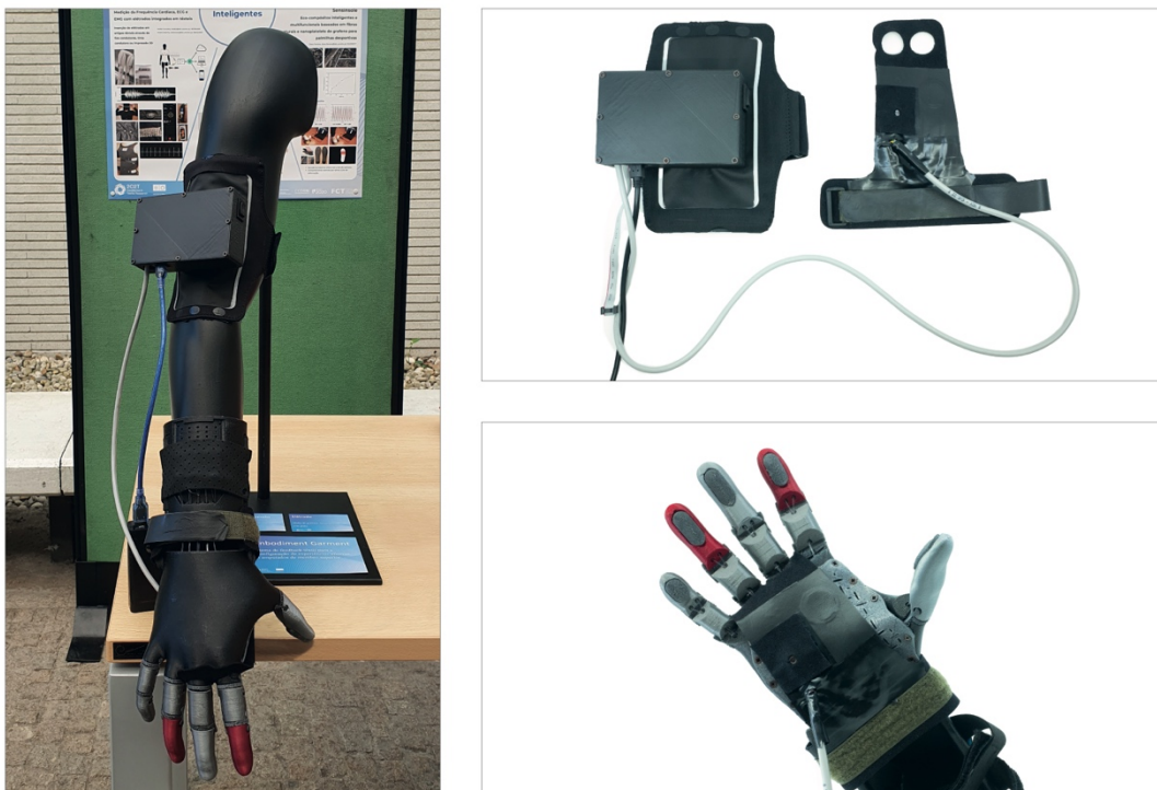
Figura 86. Sistema de feedback integrado montado e a vestir um braço.
