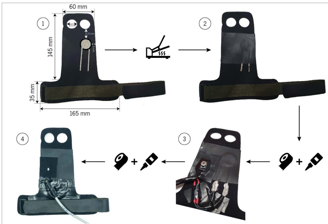
Figura 81. Esquema que ilustra o método de integração do sensor de pressão e de temperatura na supracitada luva.
