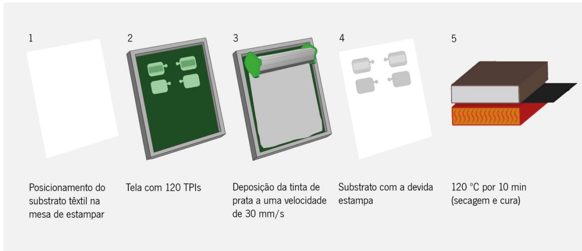
Figura 45. Esquema que ilustra o processo de estampar dos eletrodos EMS, conhecido como serigrafia.
