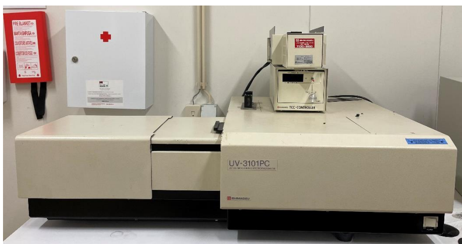
Figura 3.9 Espectrofotómetro de bancada utilizado no estudo, UVPC 3101 PC UV-VIS-NIR, da Shimadzu, Kyoto, Japão.
