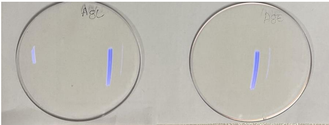
Figura 4.29 Referente às lentes nº8 após três semanas de exposição, onde à esquerda podemos ver a lente exposta ao UVC e à direita a lente não exposta, onde se mantêm intactas com o decorrer da exposição. Estas têm um reflexo azul correspondente ao filtro azul em ambas as lentes.
