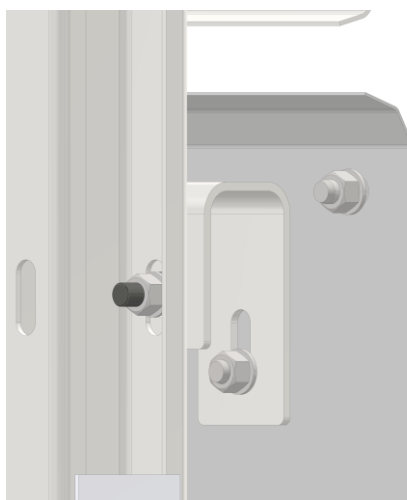
Figura 50 – Modelação geométrica dos parafusos utilizados para a ligação da suspensão em "C" com o prumo.
