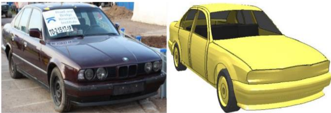
Figura 19 - Simulação numérica com veículo modelado à escala real (Wilde et al., 2020).
