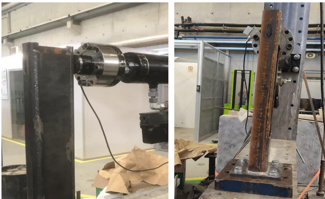
Figura 100 - Setup experimental do modelo de prumo da barreira N2W2.
