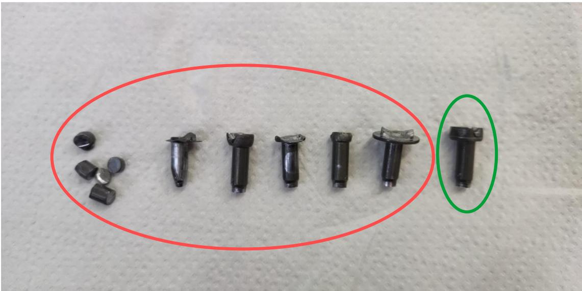
Figura 19: Exemplo de defeitos causados pela falta de material
