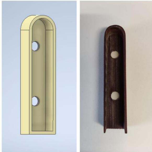
Figura 21: Modelo CAD e peça maquinada do casulo isolante do batente
