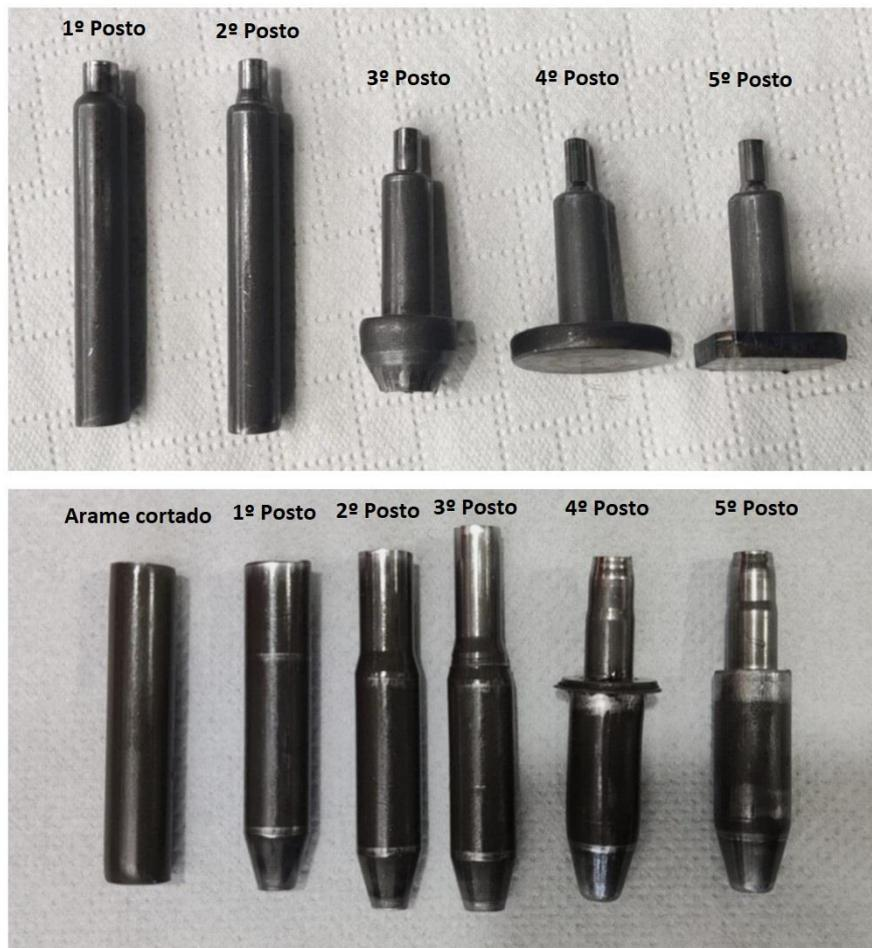
Figura 15: Etapas de fabrico de duas peças produzidas na *Multipress MP 510*
