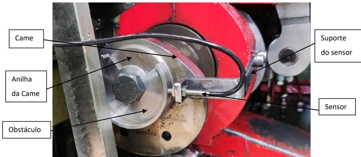
Figura 28: Montagem do sensor de auxílio
