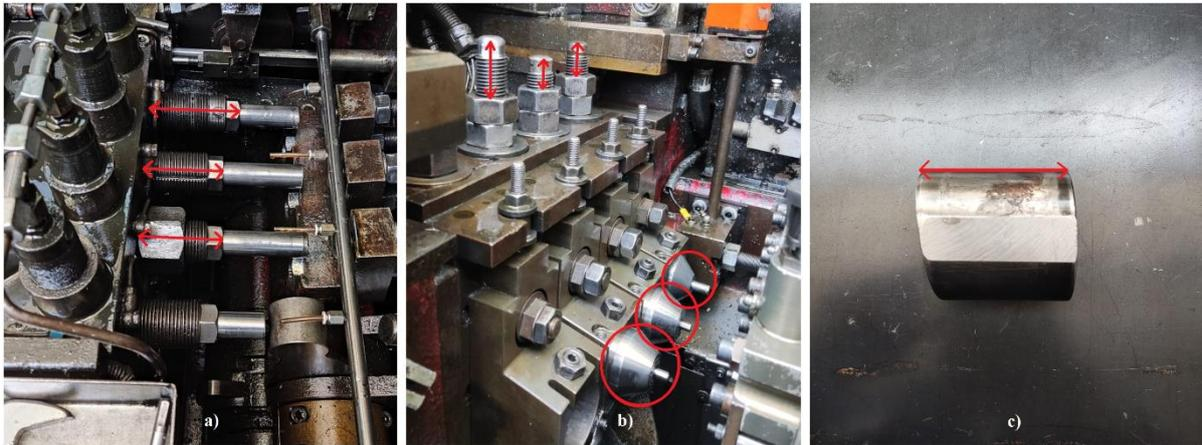
Figura 47: a) Medidas das afinações dos extratores; b) Medidas dos parafusos que ajustam o comprimento dos punções; c) Medida dos calços
