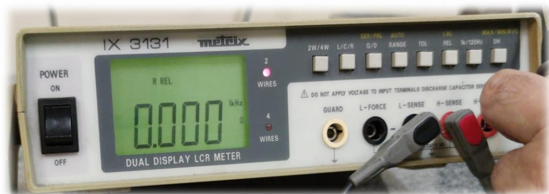
Figura 46 - Calibração do zero
