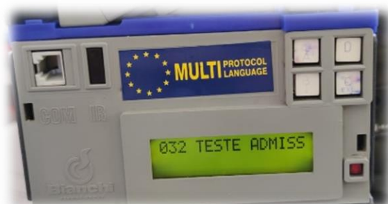
Figura 22 - Modo de teste do validador Azkoyen L66S
