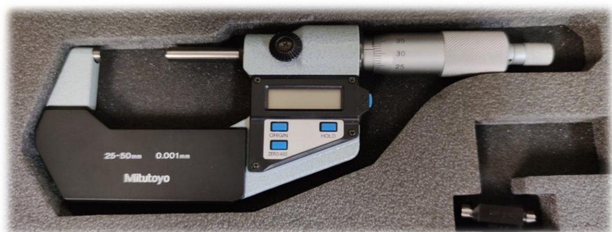
Figura 28 - Micrômetro utilizado na medição do diâmetro
