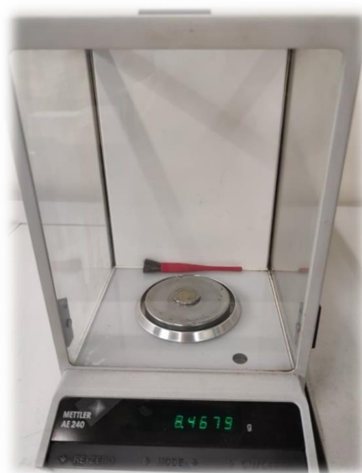
Figura 40 - Posição da moeda no prato da balança
