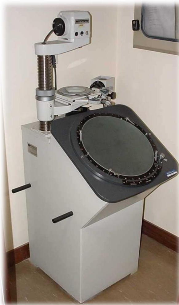
Figura 43 - Projetor de perfis utilizado na medição do diâmetro do núcleo
