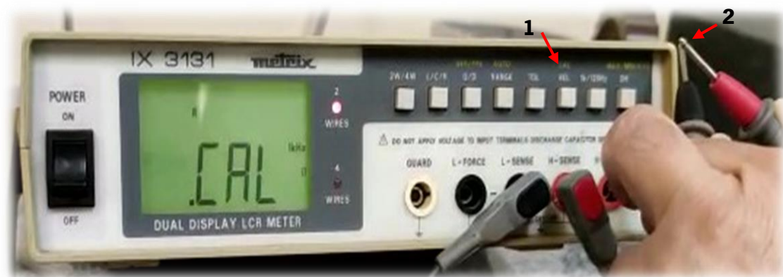
Figura 45 - Processo para a determinação do zero
