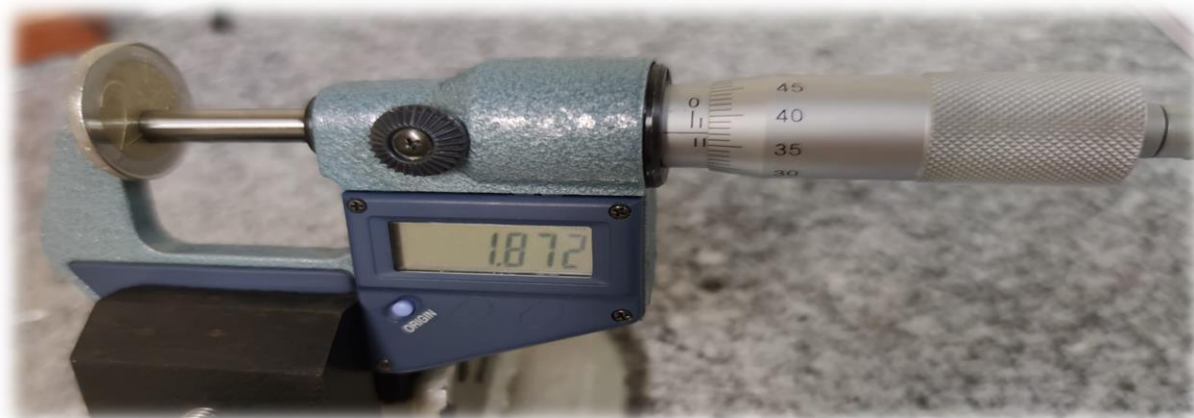
Figura 48 - Medição do núcleo da moeda
