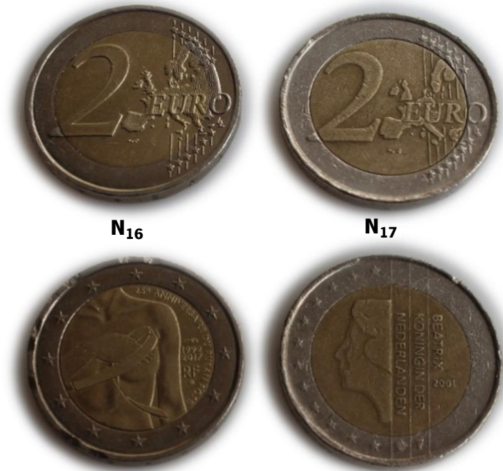
Figura 38 - Moedas com espessuras médias fora do limite de incerteza superior
