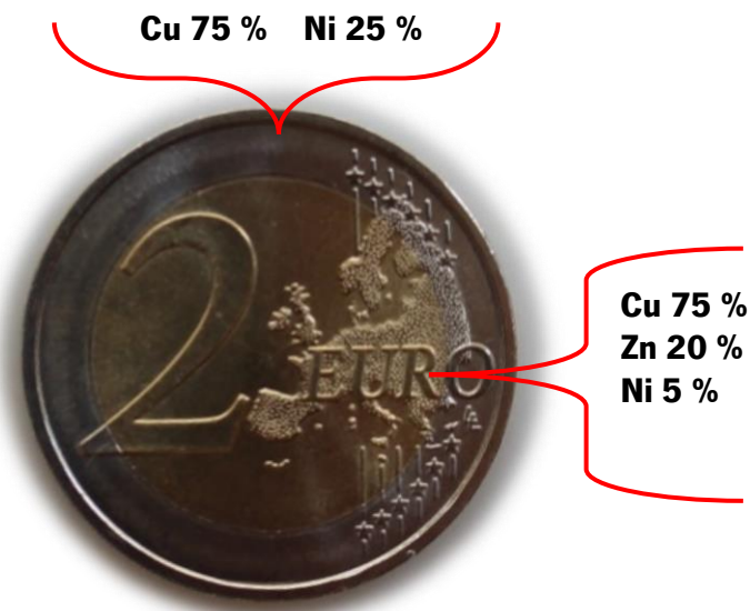
Figura 6 - Características do material da coroa e núcleo (fonte: INCM, 2021)
