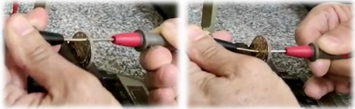
Figura 47 - Medição da resistência da coroa e da resistência do núcleo
