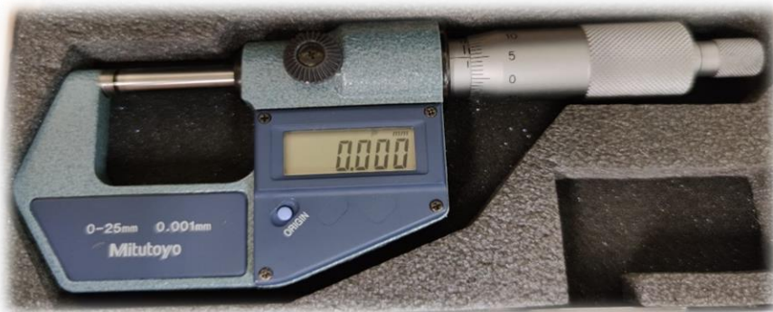
Figura 34 - Micrómetro utilizado na medição das espessuras
