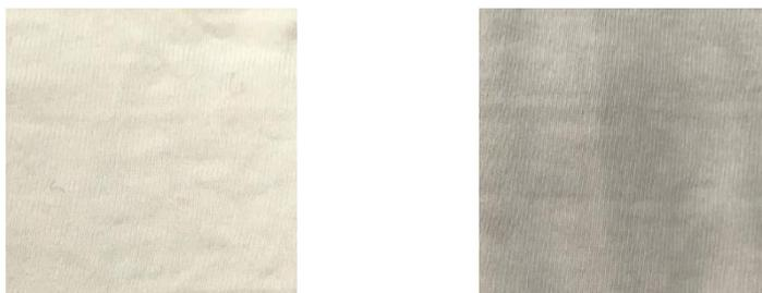
Figura 33: Substratos de algodão com meia branqueação tratados por esgotamento sem AuNPs (esquerda) e com 0,1 mg/mL AuNPs (direita).
