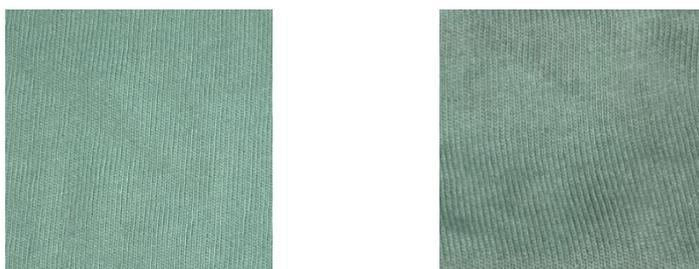
Figura 35: Substratos de mistura algodão/poliéster tratados por esgotamento sem AuNPs (esquerda) e com 0,1 mg/mL AuNPs (direita).
