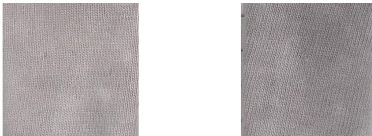
Figura 26: Amostras de CO funcionalizadas com 0,3 mg/mL de AuNPs sem ajuste de pH (esquerda) e com ajuste de pH (direita).
