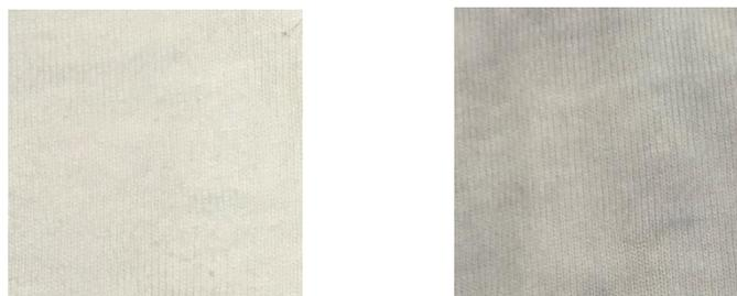
Figura 31: Amostras de algodão funcionalizadas por esgotamento com GTA, sem AuNPs (esquerda) e com AuNPs (direita).
