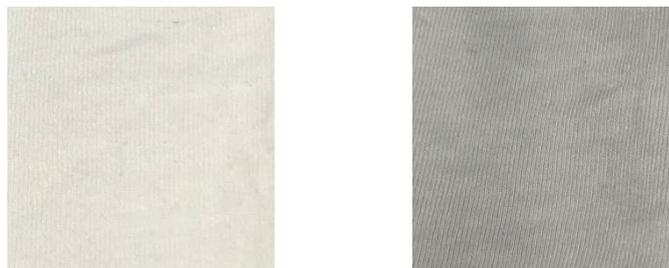
Figura 30: Amostras de algodão funcionalizadas por esgotamento com ácido cítrico, sem AuNPs (esquerda) e com AuNPs (direita).
