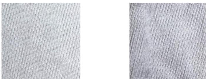
Figura 36: Substratos de poliéster tratados por esgotamento sem AuNPs (esquerda) e com 0,1 mg/mL AuNPs (direita).
