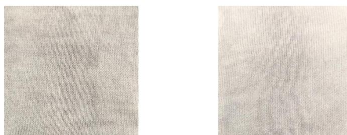
Figura 28: Substratos CO funcionalizados com AuNPs. Esquerda: Esgotamento com surfactante A + surfactante D; Direita: Esgotamento com surfactante B + surfactante D.
