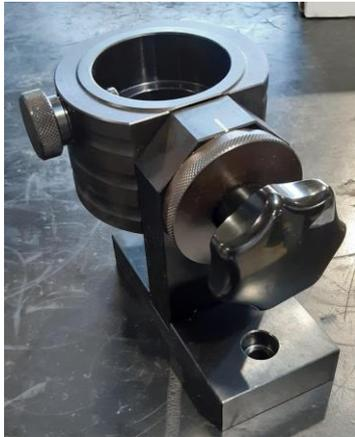
Figura 60. Acessório de troca de ferramentas necessário para o TORN50.
