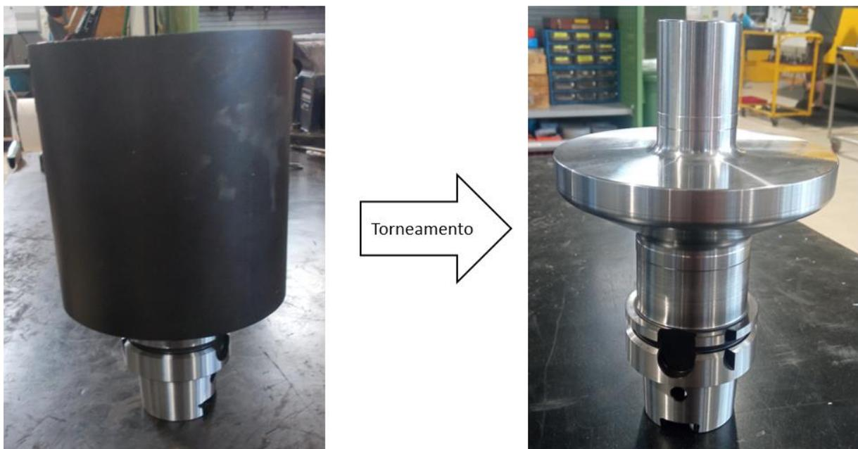
Figura 28. Exemplo de transformação ocorrida no Torneamento, numa ferramenta da família E991.
