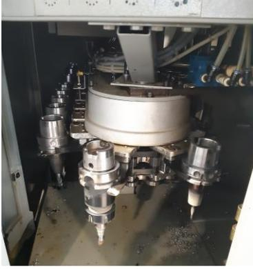
Figura 90. Torreta de uma máquina, com ferramentas de maquinação.
