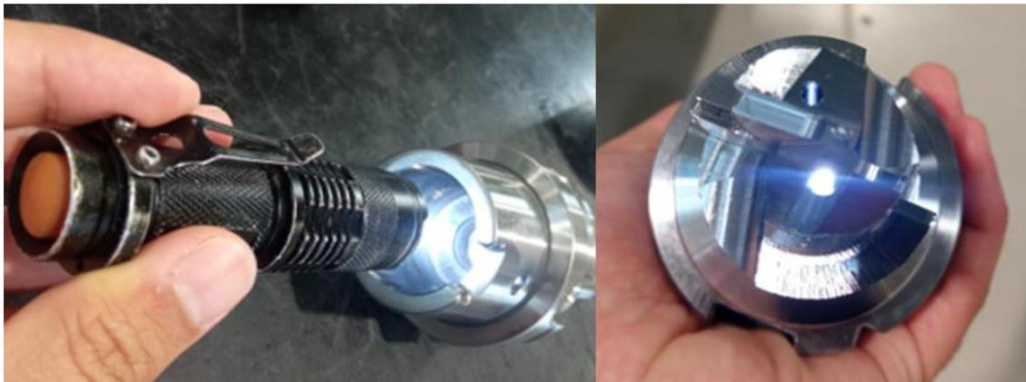
Figura 66. Utilização de lanterna para verificar furos de lubrificação das ferramentas.
