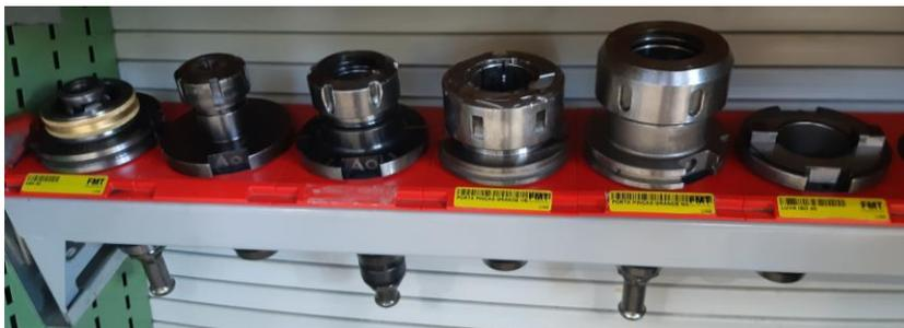
Figura 89. Exemplos de apertos das máquinas.
