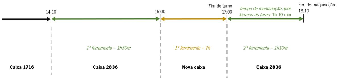
Figura 76. Distribuição do tempo de Fresagem de um dia, com otimização do “tempo livre” e de maquinação após término do turno.
