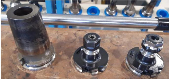
Figura 87. Exemplos de apertos de ferramentas de maquinação.
