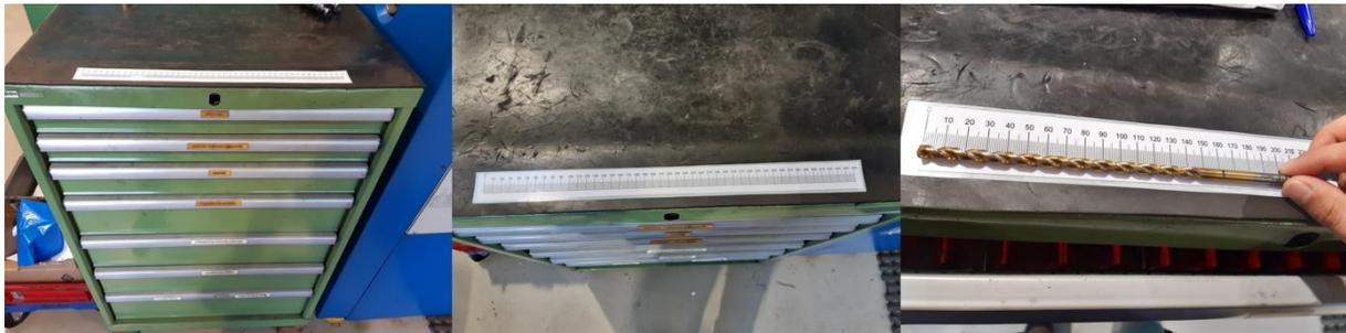
Figura 61. Régua implementada para medição de brocas.
