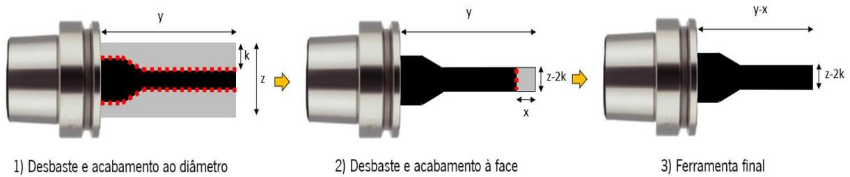
Figura 40. Esboço de estratégia de maquinação mais eficiente do que a utilizada no início do projeto.
