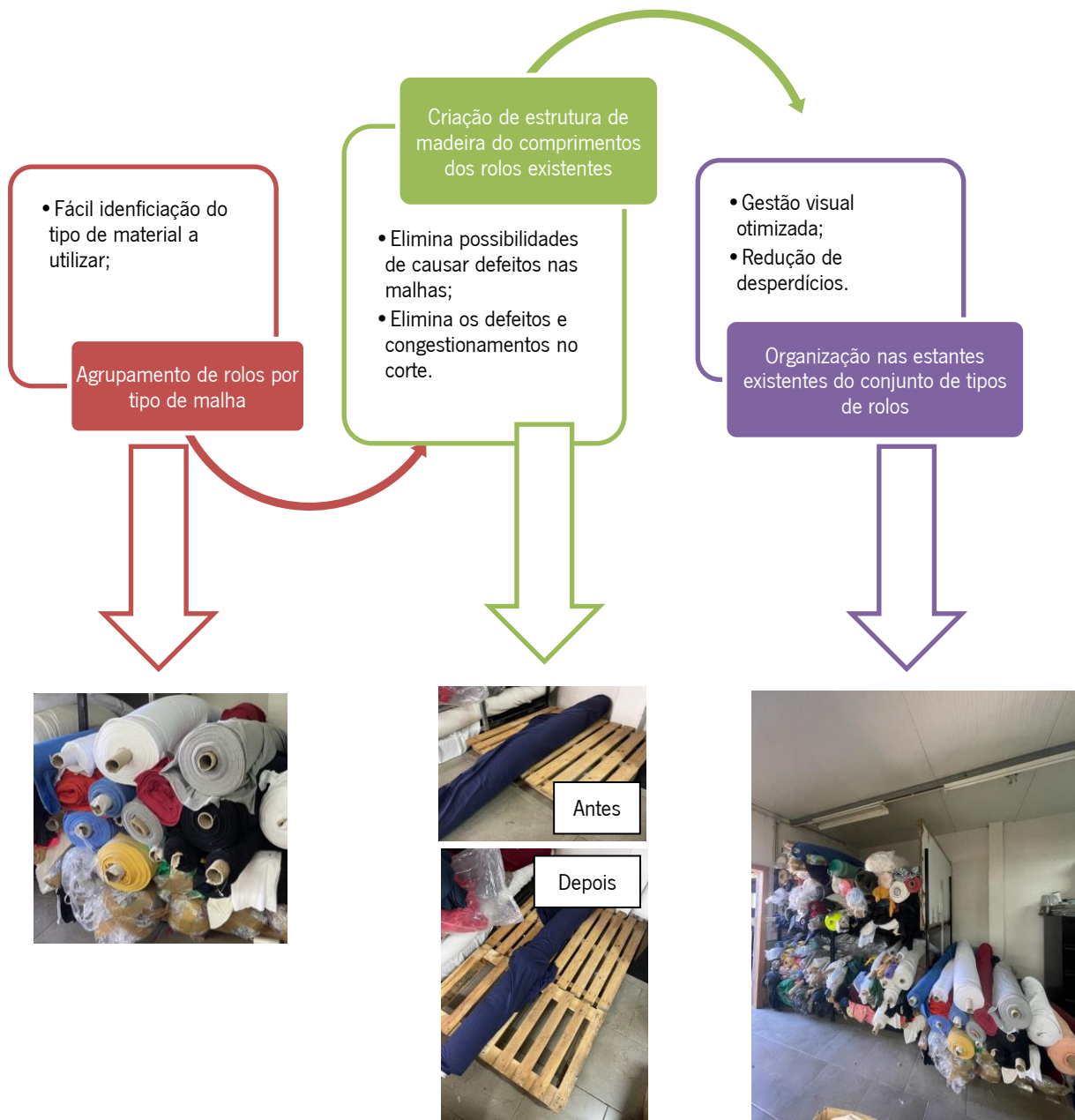
Figura 31 - Sequência de intervenções no armazém dos rolos de malha
