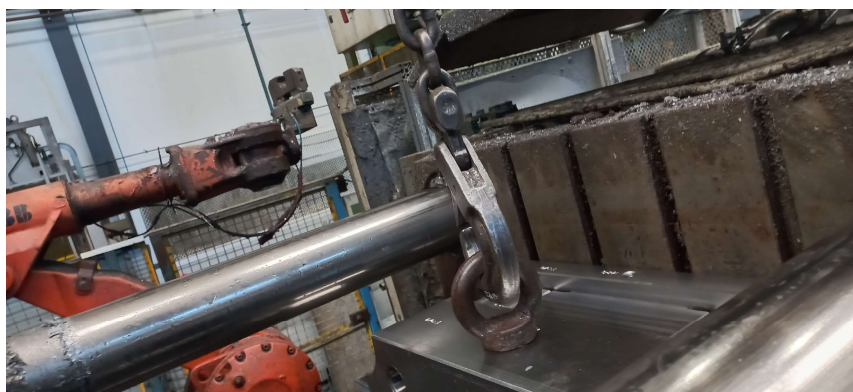
Figura 22 - Ponte conectada ao molde
