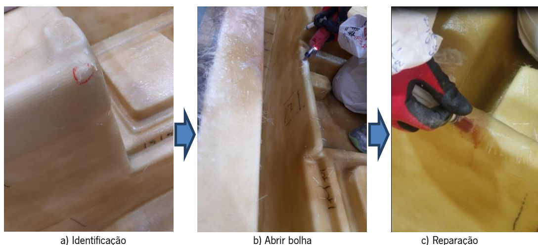
Figura 83 - Processo de reparação de bolhas na laminação
