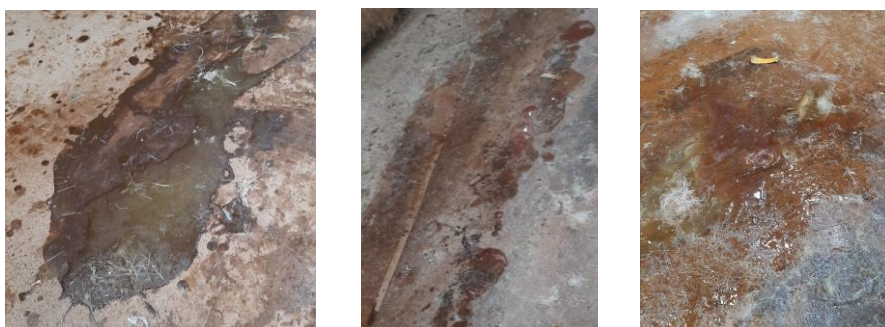
Figura 66 - Desperdício de Resina escorrido dos cascos
