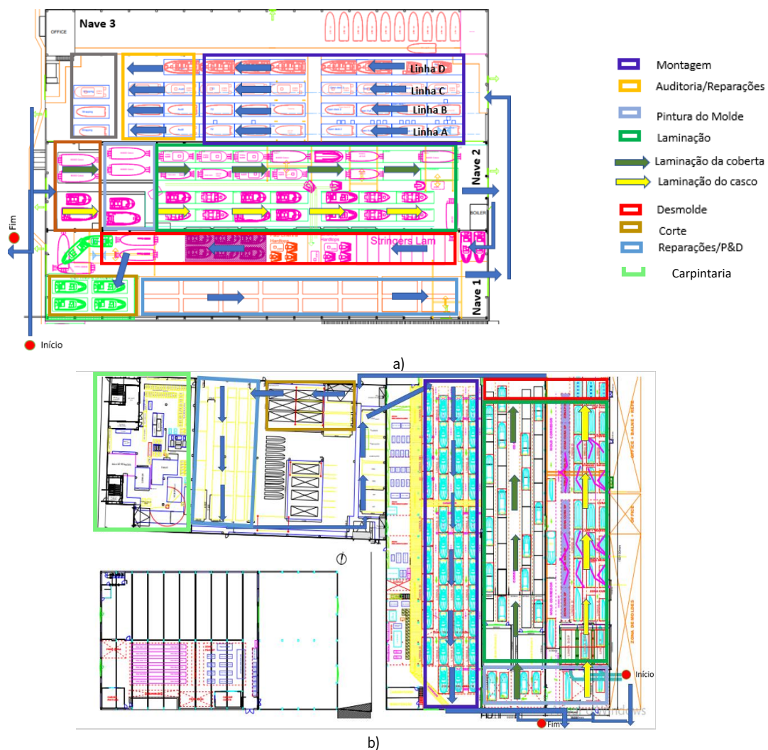
Figura 84 - Fluxo antigo (a) vs. Fluxo novo (b)
