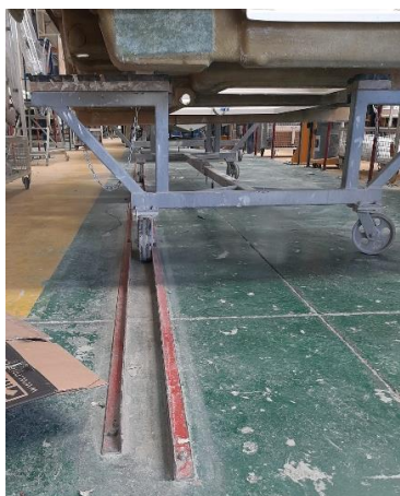
Figura 92 - Suporte para o transporte de barcos na montagem
