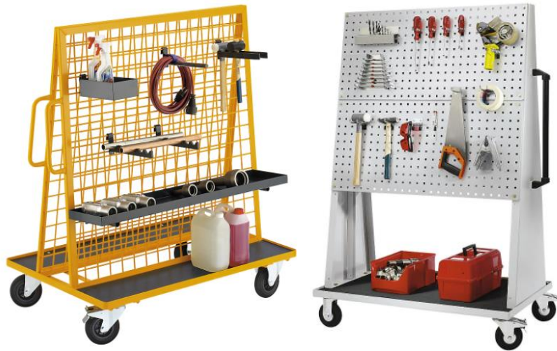
Figura 93 - Proposta de design para o carrinho de distribuição de ferramentas (montagem)
