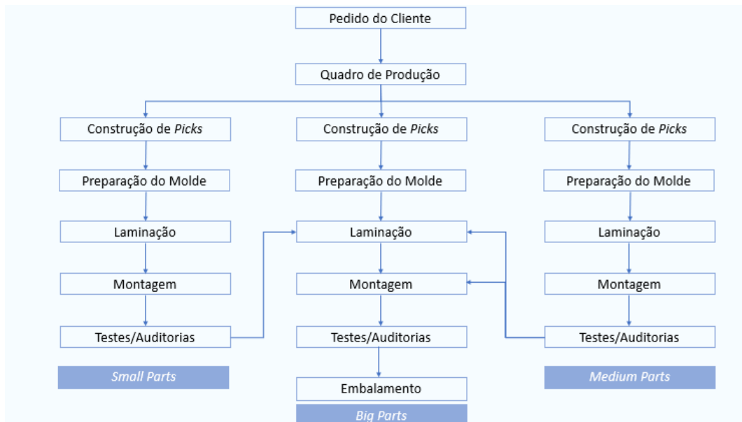
Figura 15 - Processo Produtivo por tipo de componente
