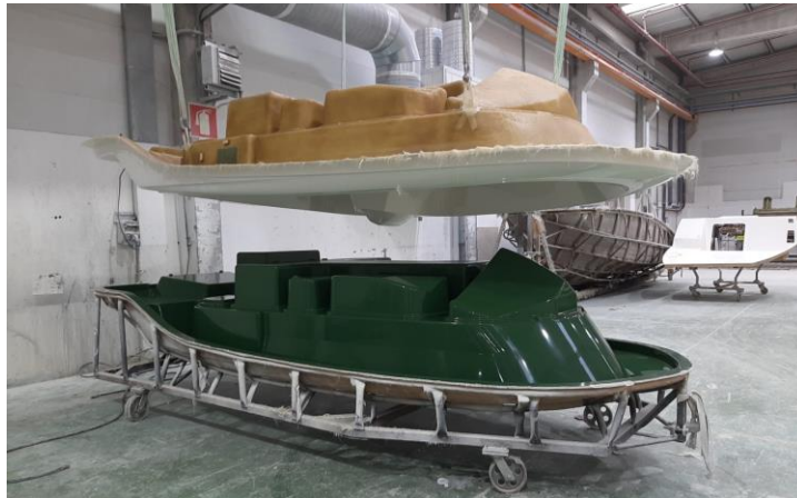
Figura 26 - Coberta em fase de POP
