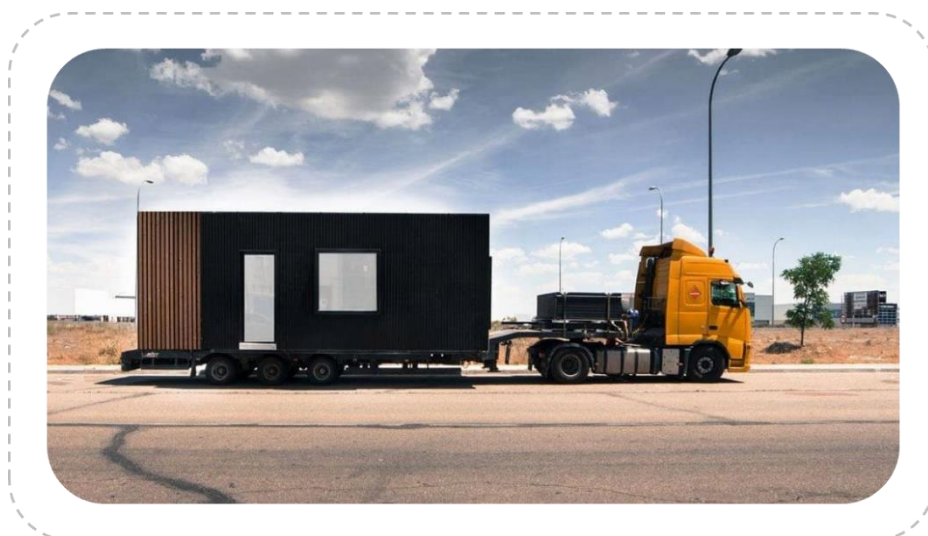
Figure 10 – Truck transports the modular building (¿Cómo se hace una Construcción Modular? | © Neoblock Modular)
