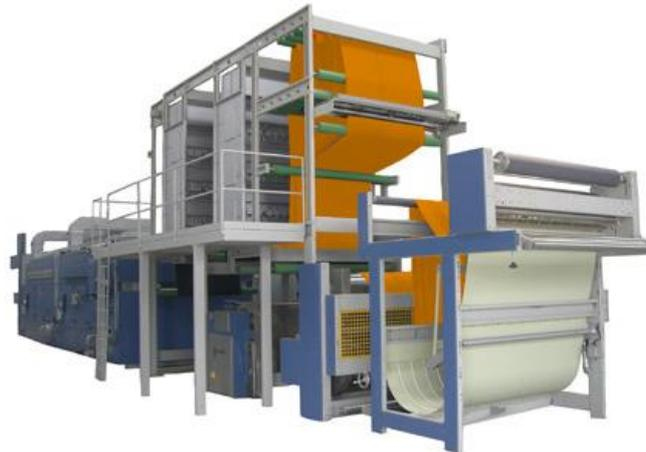
*Figura 1 - Máquina de tingimento por impregnação*
