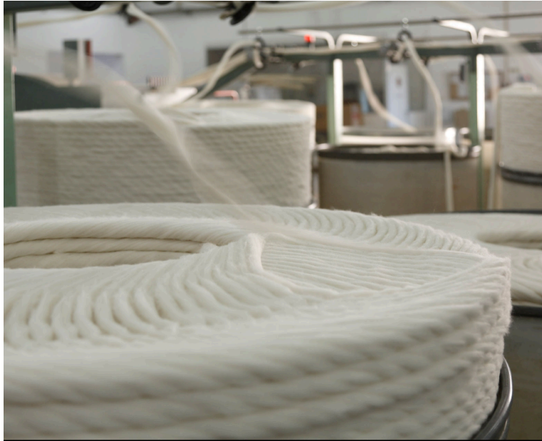
Figura 18 – Produto intermédio após processo cardação
