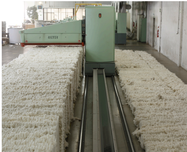
Figura 17 - Processo abertura e pré-limpeza
