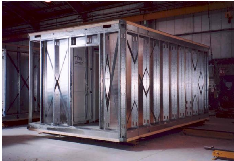
Figura 18- Estrutura para construção modular em aço leve [15].
