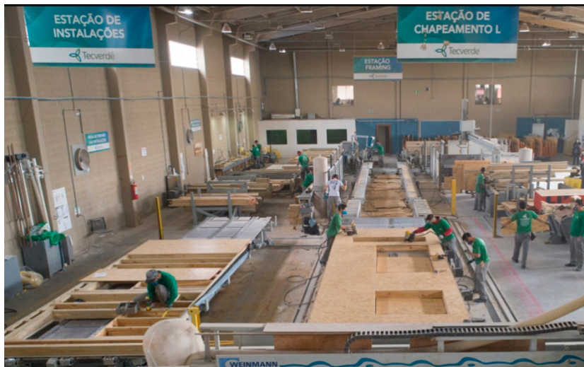
Figura 23 – Introdução das instalações no módulo [18].
