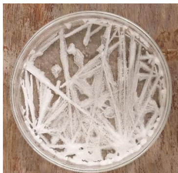
Figura 4: \text{g-C}_3\text{N}_4 poroso dopado com enxofre.
