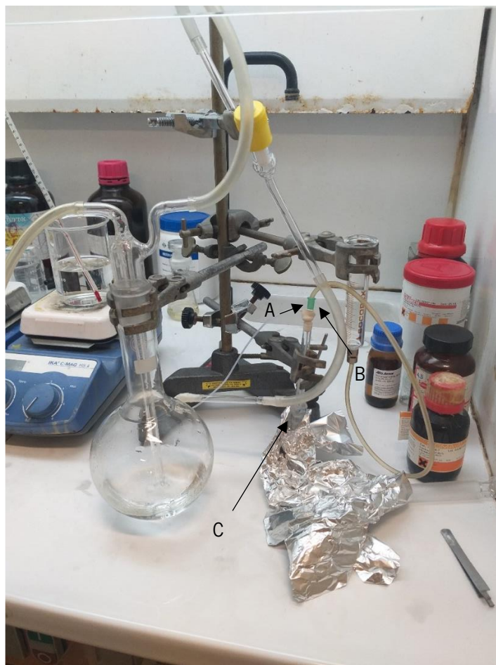
Figura 7: Montagem para o desarejamento nos ensaios com platina. A: corrente de azoto; B: recolha de azoto para a seringa; C: célula com a solução e onde borbulha o azoto.
