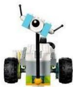
1. Nesta atividade vais trabalhar com sensores (sensor de inclinação) que verifica a posição do sensor relativamente ao plano. Este método será usado para o robô Milo para enviar mensagens!
