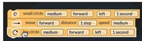
6. Verifica se tens o robô ligado ao tablet/computador e envia o programa para o Ozobot. Observa o seu comportamento, altera os parâmetros dos três blocos anteriores e envia novamente o programa para o robô.
