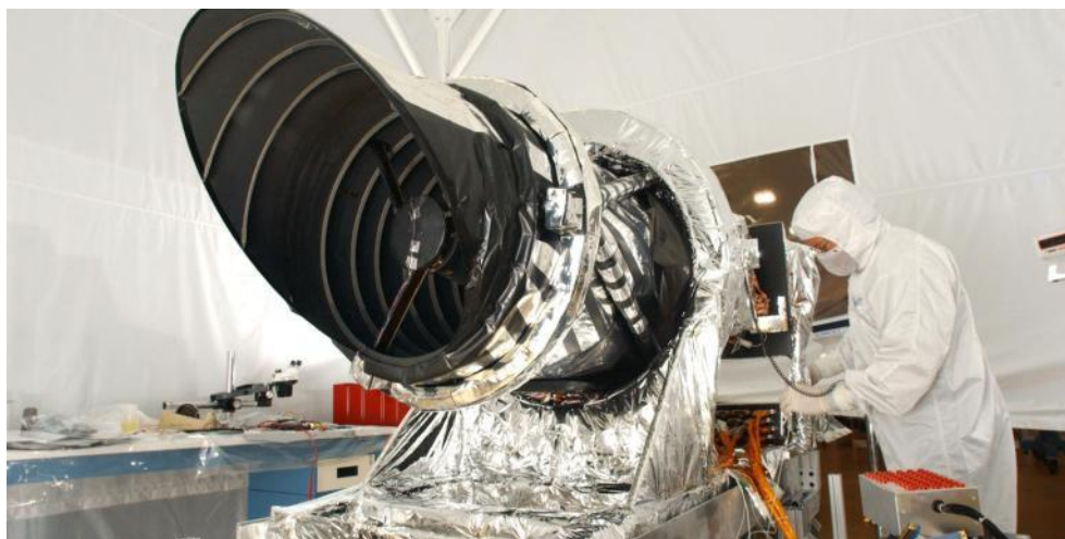
Figura 23 Foto do instrumento HiRISE, durante os últimos preparativos pré-montagem no orbitador MRO. (Crédito: NASA/JPL)
