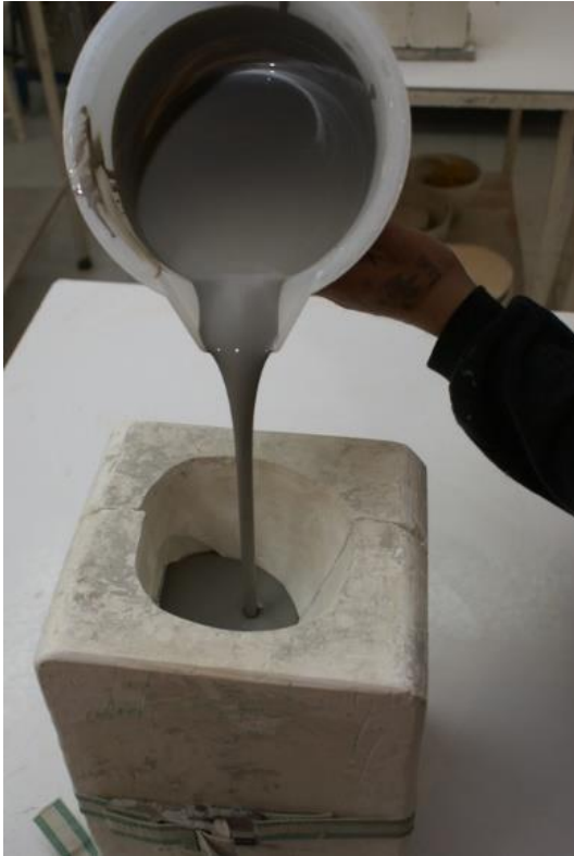
Figura 25 – Modelação por molde (gesso). Fonte: Talismanni
