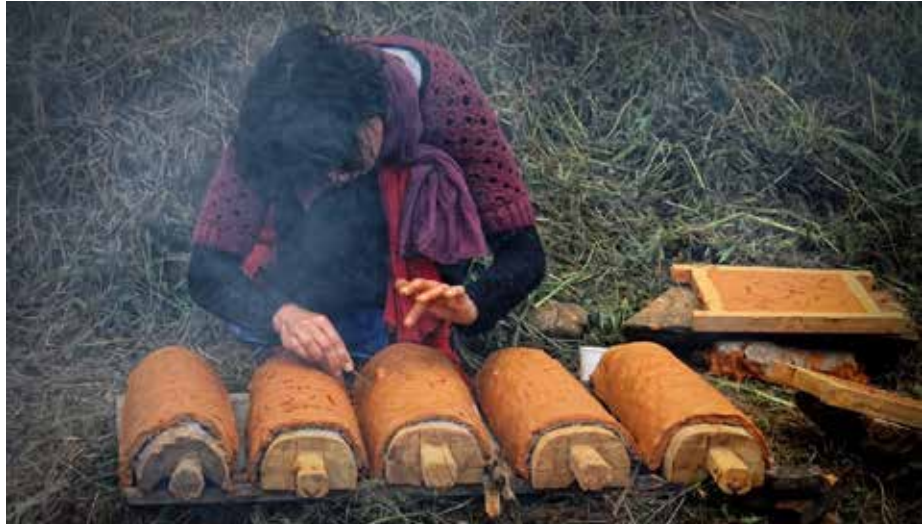
III.II_ figura 4 processo manual de produção de telha em Romariz, antigo lugar pertencente a Nunes, 2010
