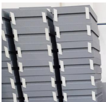
Figura 68 - Colocação de fita dupla face na montagem de gavetas de perfil
