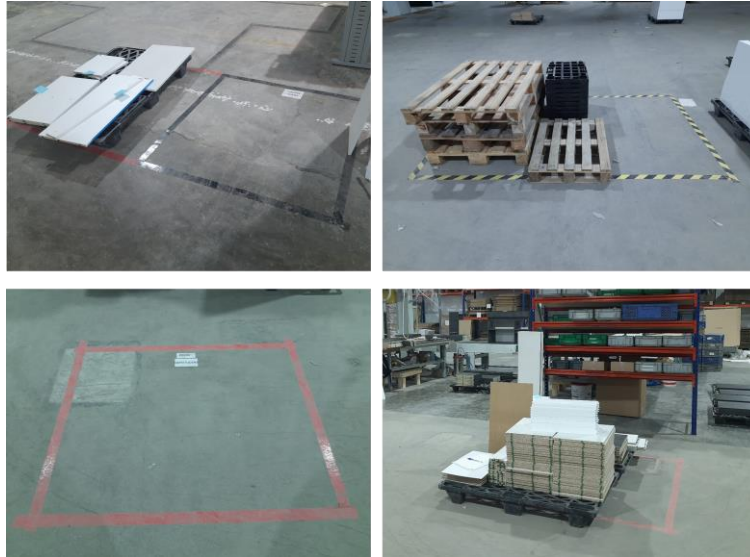
Figura 91 - Demarcação dos espaços para peças com defeito, móveis em espera e paletes
