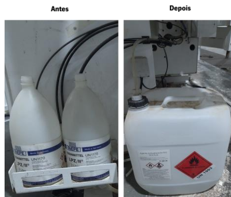
Figura 87 - Substituição dos recipientes de 2 litros utilizados nas orladoras
