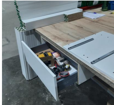
Figura 93 - Criação de gavetas nas mesas da pré-montagem para o armazenamento de ferramentas
