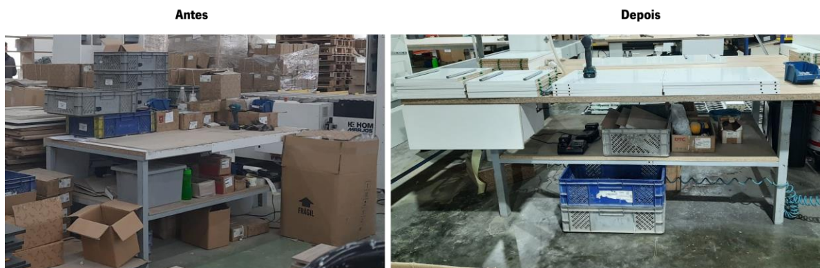
Figura 92 - Postos de trabalho da pré-montagem antes e depois da implementação de 5S
