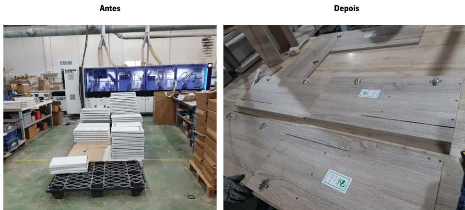
Figura 65 - Stock intermédio de ilhargas/prumos antes e depois das melhorias implementadas
