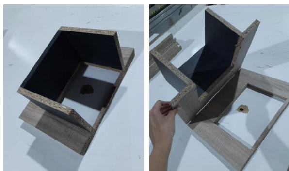
Figura 66 - Protótipo do molde elaborado para a montagem das gavetas de perfil
