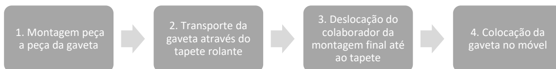
Figura 69 - Sequência das tarefas realizadas aquando da produção peça a peça das gavetas ultrabox
