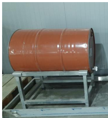
Figura 53 - Colocação do bidão de diluente de limpeza na horizontal
