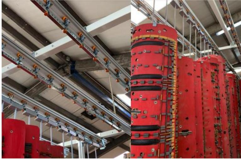
*Figura 50 - Imagem representativa do mecanismo para armazenamento dos cortantes rotativos*
