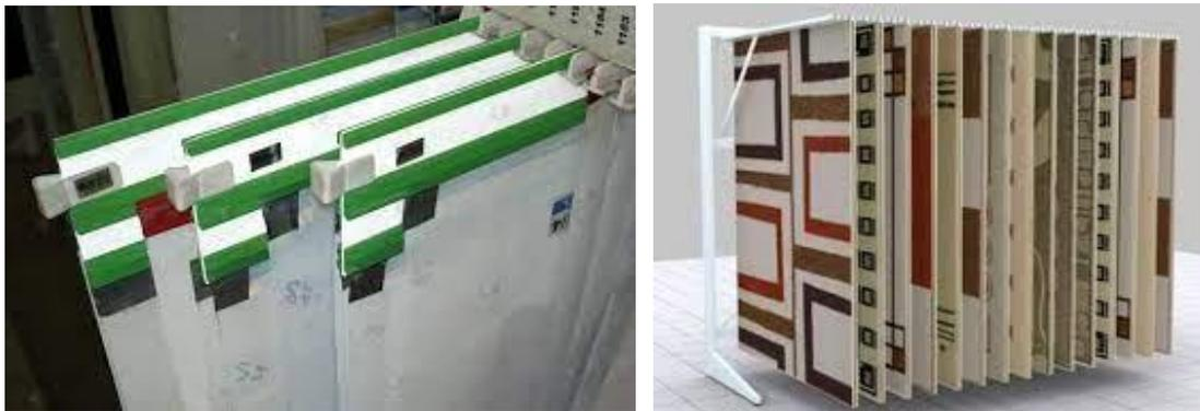
*Figura 43 - Suporte e plataforma para armazenar os clichés*
