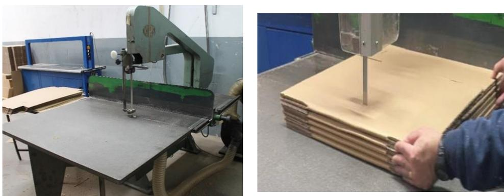
*Figura 14 - Serra de Fita e procedimento de corte*
