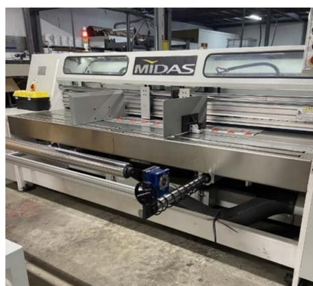
*Figura 15 - Máquina de corte e vinco manual e slitter*
