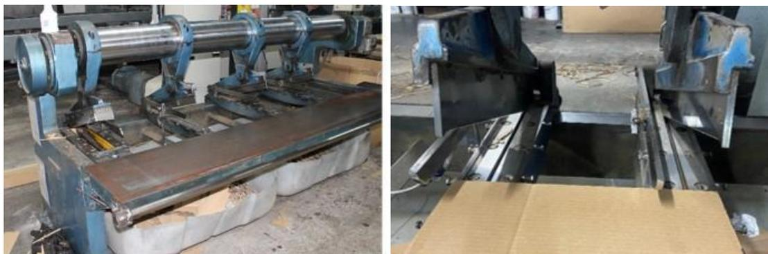
*Figura 17 - Máquina de escatelar e procedimento de escatelagem*
