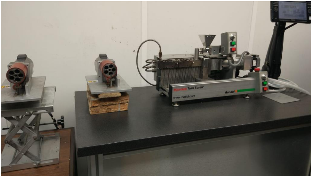
Figura 17: Extrusora Rondol Microlab utilizada para a produção dos filamentos.
