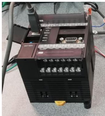
Figura 4.1 - PLC utilizado no dispositivo
