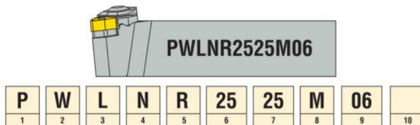
Figura 2.21- Porta ferramentas para torneamento externo e respetivo código (adaptado de (SecoTools, 2008) ).
