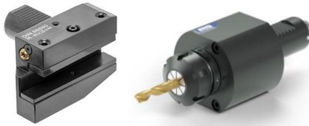
Figura 2.19- Porta ferramentas VDI estático e accionado respetivamente.
