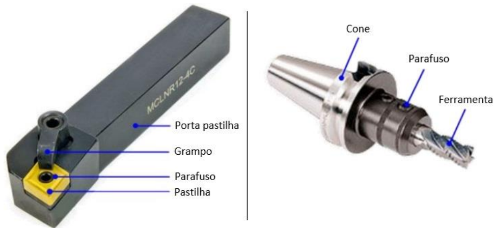
Figura 2.6- Anatomia de ferramenta para tornear, à esquerda, e para fresar, à direita.
