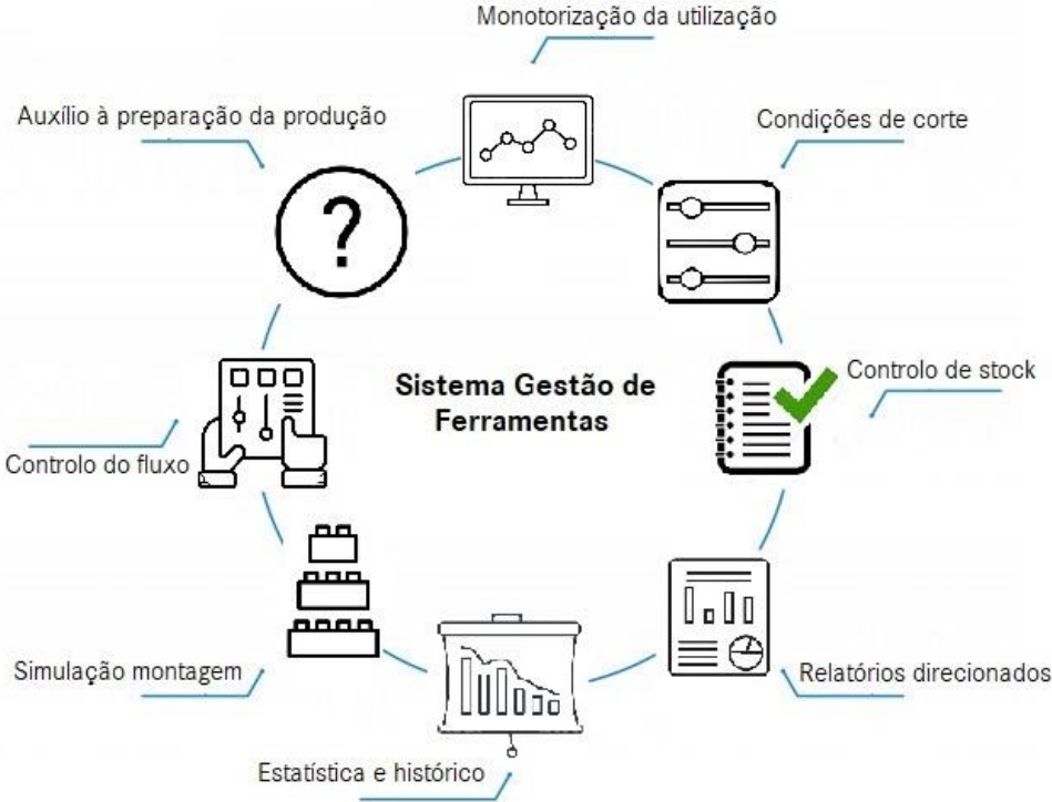
Figura 2.28- Funções de um software especializado na gestão de ferramentas (adaptado de (Junior, 2007)).
