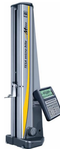
Figura 3.7- Equipamento de metrologia - Micro-hite.
