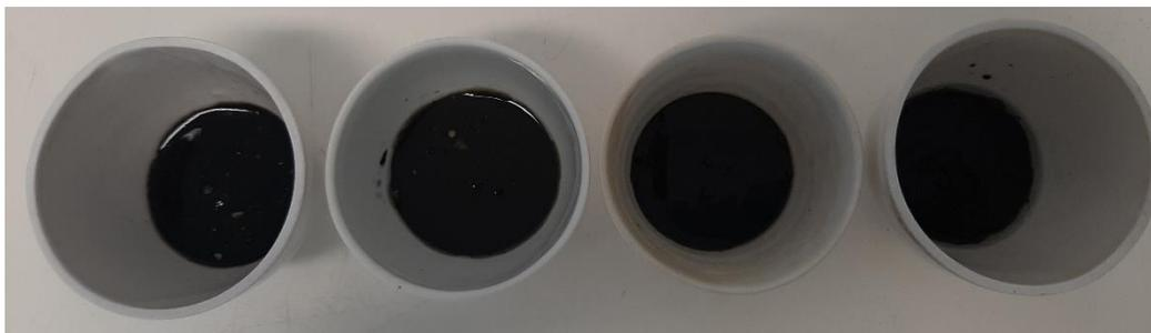
Figura 63 - Cadinhos com o conteúdo dos frascos antes de estarem na mufla para a determinação de sólidos voláteis. Da esquerda para a direita, encontra-se o branco, celulose, PHA e APIMAT.
