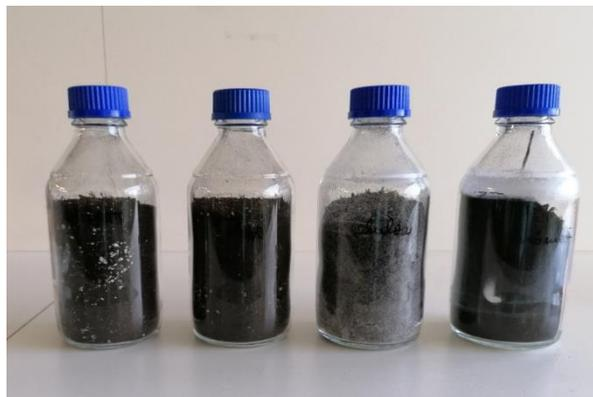
Figura 27 - Frascos de compostagem antes de iniciar o ensaio, da esquerda para a direita em primeiro o APIMAT, seguido do PLA, celulose e branco.
