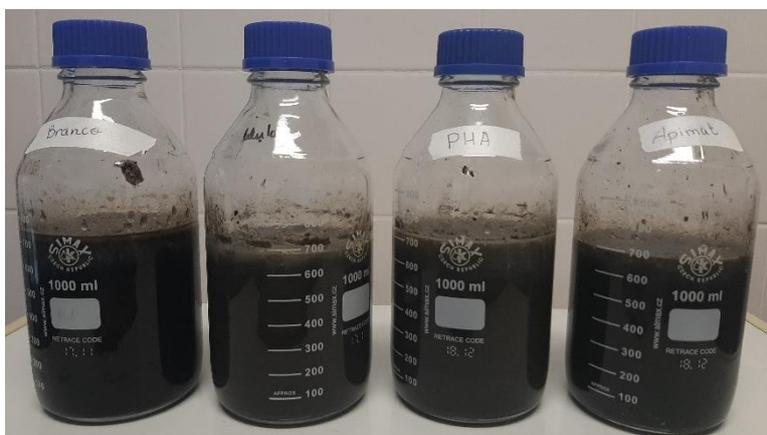
Figura 60 - Frascos no fim dos ensaios de biodegradabilidade anaeróbia, da esquerda para a direita, encontra-se o branco, a celulose, o PHA e o APIMAT.
