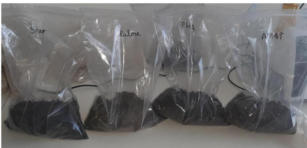
Figura 52 - Conteúdo dos frascos no fim do ensaio de biodegradabilidade aeróbia, da esquerda para a direita, encontra-se o branco, a celulose, o PHA e o APIMAT.
