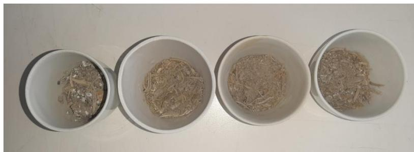
Figura 54 - Cadinhos com o conteúdo dos frascos após estarem na mufla para a determinação de sólidos voláteis. Da esquerda para a direita encontra-se o APIMAT, o branco, a celulose e o PHA.
