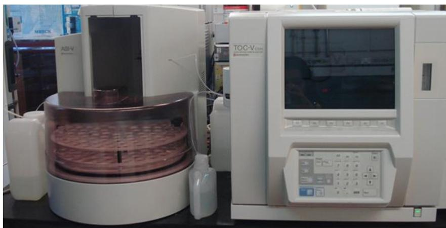
Figura 34 - Analisador de carbono *Shimadzu TOC-V CSH*.
