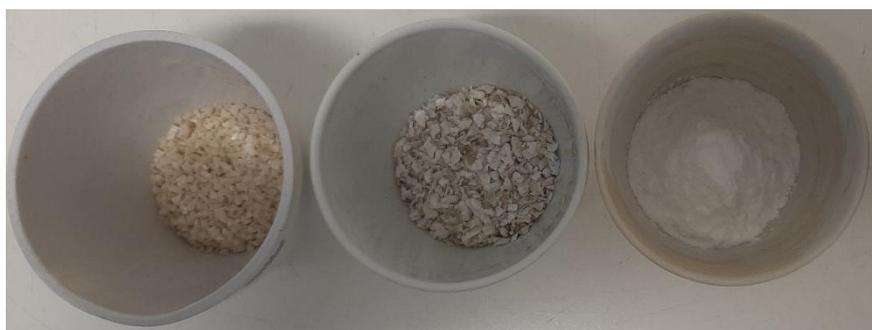
Figura 44 - Materiais em teste antes de serem colocados na mufia, para os ensaios de sólidos voláteis. Da esquerda para a direita tem-se o PHA, APIMAT e celulose (material de referência).
