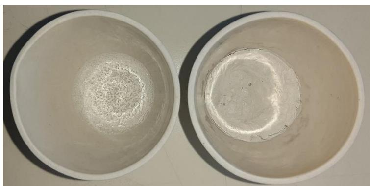
Figura 45 - PHA e APIMAT depois de serem colocados na mufia, para os ensaios de sólidos voláteis. Da esquerda para a direita tem-se o PHA e o APIMAT.
