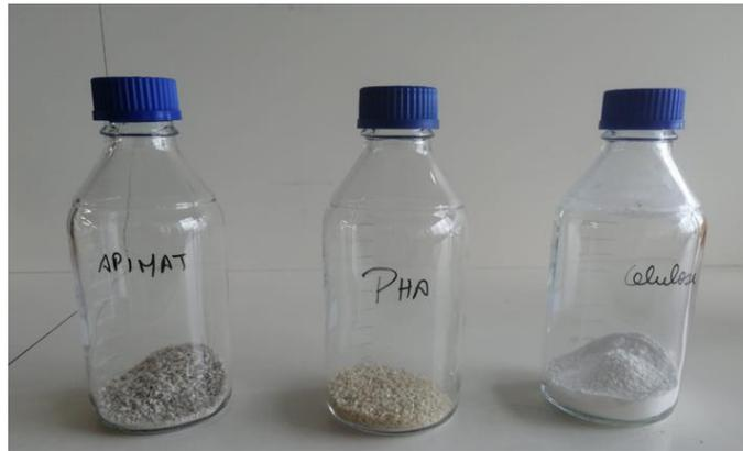
Figura 26 - Materiais em teste (APIMAT e PHA) e material de referência (celulose) nos frascos de compostagem, da esquerda para a direita.
