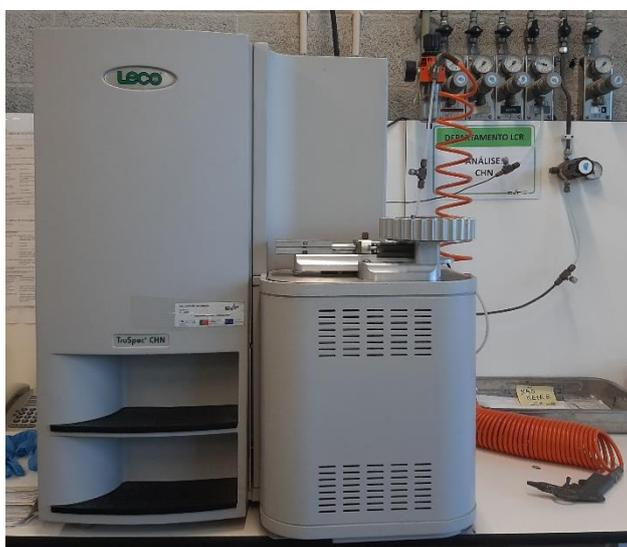
Figura 36 - Analisador elementar *TruSpec CHN Leco*.
