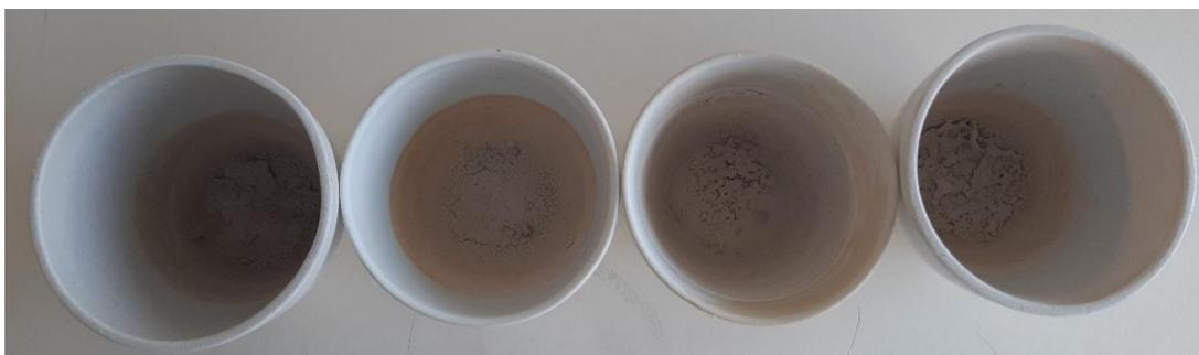
Figura 64 - Cadinhos com o conteúdo dos frascos depois de estarem na mufla para a determinação de sólidos voláteis. Da esquerda para a direita, encontra-se o branco, celulose, PHA e APIMAT.
