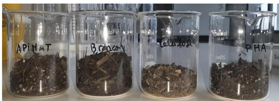
Figura 53 - Copos com o conteúdo dos frascos após estarem na estufa, para a determinação dos ensaios de sólidos secos totais e teor de humidade. Da esquerda para a direita, encontra-se o APIMAT, o branco, a celulose e o PHA.
