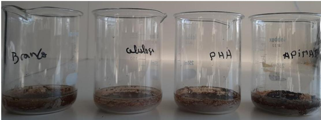
Figura 62 - Copos com o conteúdo dos frascos depois de estarem na estufa, para a determinação dos sólidos secos totais e do teor de humidade. Da esquerda para a direita, encontra-se o branco, celulose, PHA e APIMAT.
