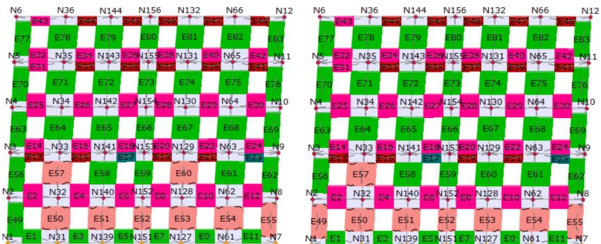
Figura 5-12- Distribuição de danos na parede WX1 para a força máxima, distribuição uniforme (à esquerda) e modo fundamental (à direita) na direção X sentido positivo
