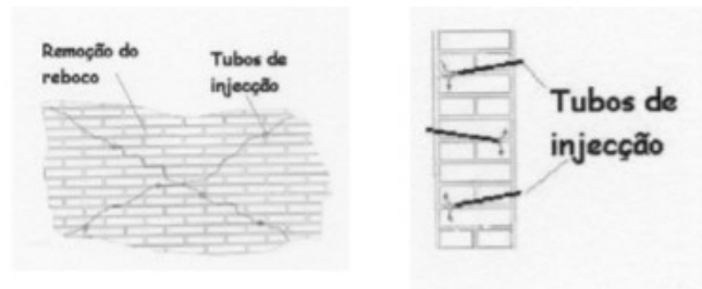
Figura 2-19 - Consolidação por injeção
