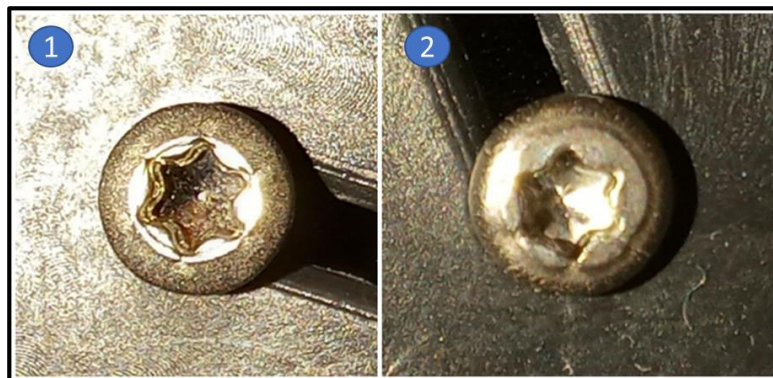
Figura 59 – Parafuso n°1 Ok e Parafuso n°2 NOk
