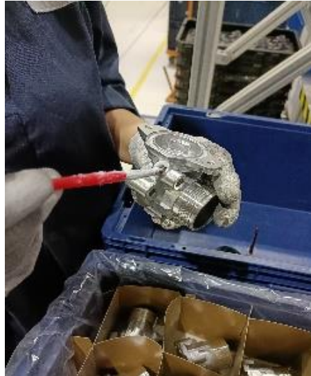
Figura 37 – Colocação de grease no housing
