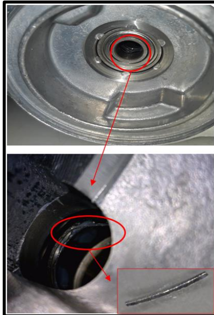
Figura 66 – Presença de limalhas no Shaft Seal
