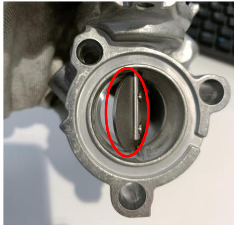
Figura 24 – Assemblagem da flap com o solenoide
