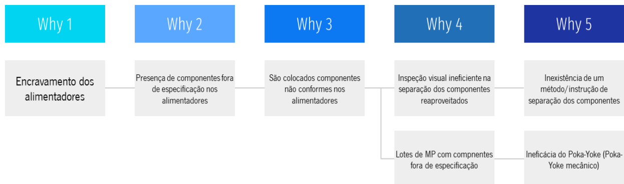
Figura 55 – 5 Why's para a falha nos alimentadores
