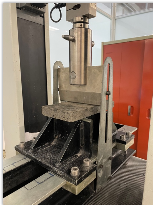
Figura 26 - Ensaio de resistência à flexão sob carga centrada.
