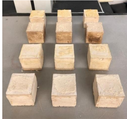
Figura 3.7 – Provetes de 50x50x50mm 3 após 28 dias em estufa à 50°C.
