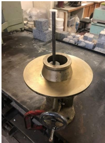
Figura 3.9 – Instrumentos utilizados no ensaio de espalhamento.
