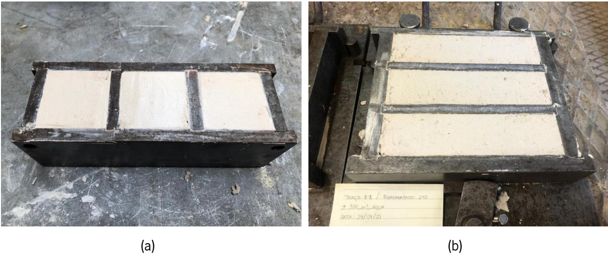
Figura 3.11 – (a) Moldagem das pastas em moldes de 50x50x50mm 3 e (b) Moldagem das argamassas em moldes de 40x40x160mm 3 .
