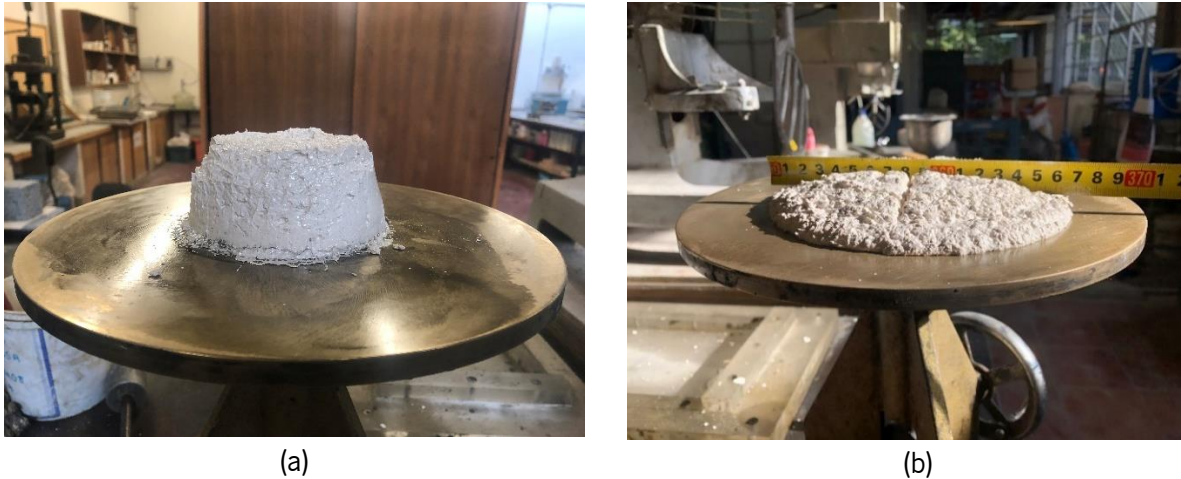
Figura 4.4 – (a) Argamassa composta por água, pó de conchas de ostras e agregado (C3) em ensaio de consistência por espalhamento e (b) Medição do espalhamento após o processo de 10 pancadas.
