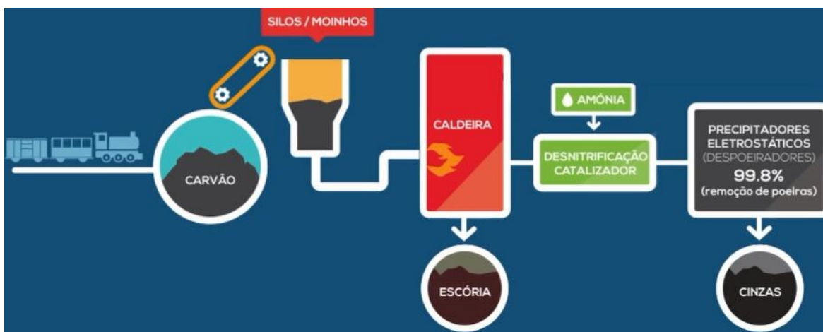
Figura 3.5 - Esquema ilustrativo do processo de produção das cinzas volantes na Central do Pego. Fonte: PEGOP (2016)
