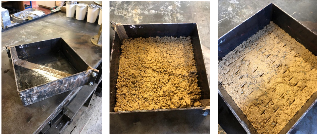
Figura 24- Procedimento de enchimento de molde quadrangular com a argamassa inferior
