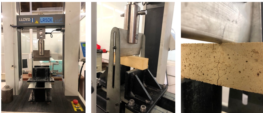
Figura 27- Realização de ensaio de resistência à tração na flexão, na LLOYD.
