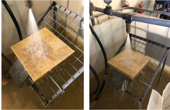
Figura 34- Procedimento de ensaio de erosão acelerada por jato de água em tanque simulador de chuva.
