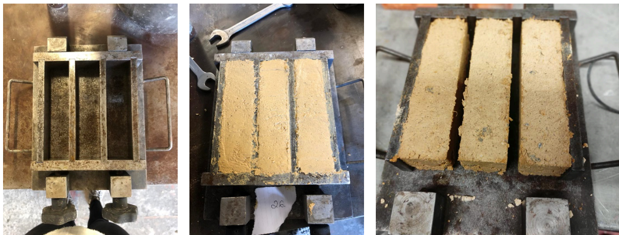
Figura 23- Procedimento de preenchimento e desmoldagem de provetes prismáticos
