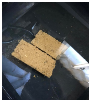
Figura 31- Ensaio de absorção de água por imersão
