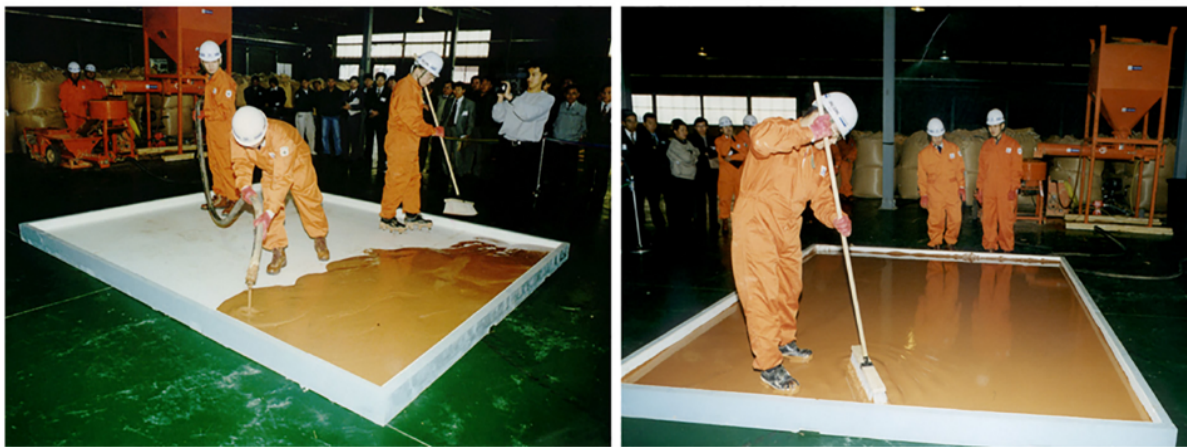
Figura 9- Demonstração de betão de terra autonivelante com estabilização com cal, Coreia (Damme & Houben, 2018)
