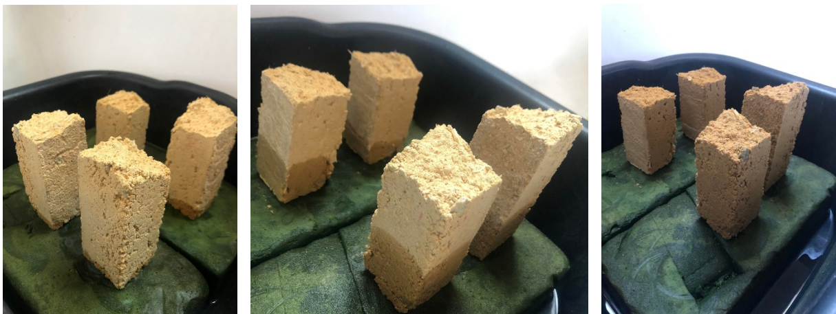
Figura 30- Procedimento da realização do ensaio de absorção de água por capilaridade
