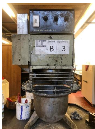
Figura 22- Misturadora mecânica do Laboratório de Materiais de Construção da UM.
