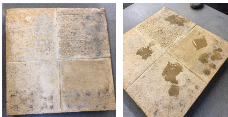
Figura 33- 1. Polimento com pedra 2. Procedimento de ensaio de absorção de gota de água
