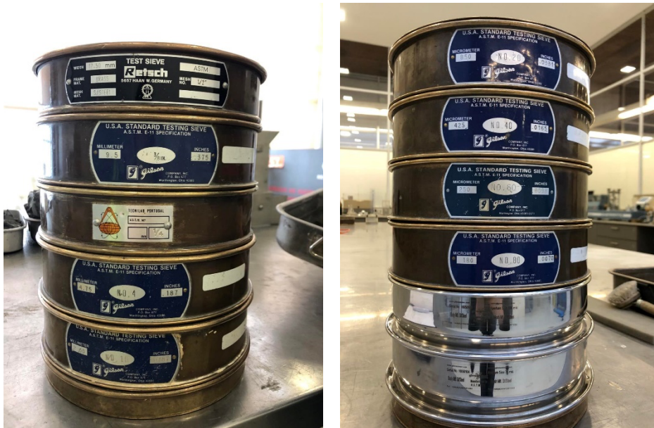
Figura 12- Peneiros utilizados na granulometria. 1- Granulometria dos grossos (peneiro de 2,00mm a 12,50mm. 2- Granulometria dos finos (peneiro de 75 mic a 850 mic)
