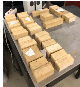
Figura 28- Prismas partidos no ensaio de tração na flexão
