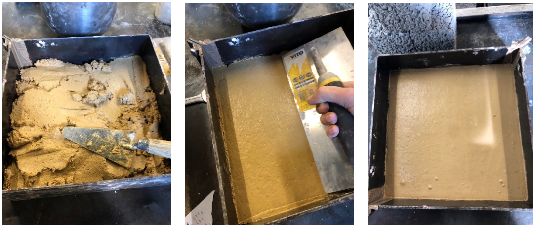
Figura 25- Procedimento de enchimento de molde quadrangular com a argamassa final
