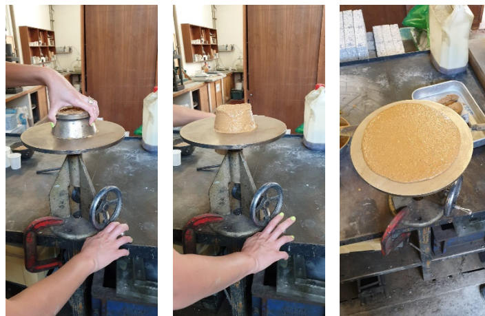
Figura 26- Procedimento do ensaio de espalhamento
