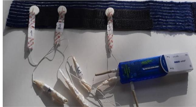
16) Fixar com o sistema de velcro (macho-fêmea) à sonda de temperatura à cinta elástica. Nesta fixação, deve ser assegurado, que a parte final da sonda de temperatura, o sensor da sonda está em total contacto com o disco de proteção, para ser isolada do meio ambiente.
