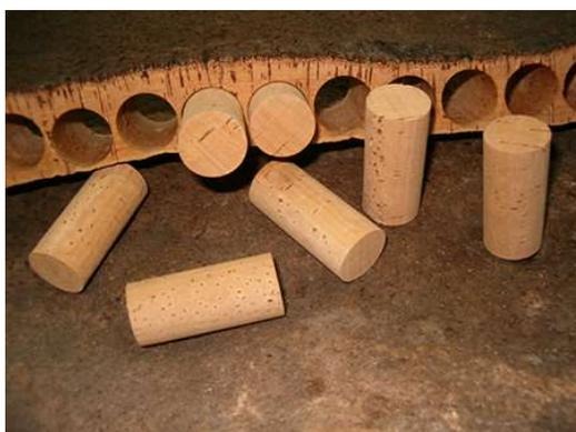
Figura 27 - Visualização de como é extraída a rolha do traço de cortiça
