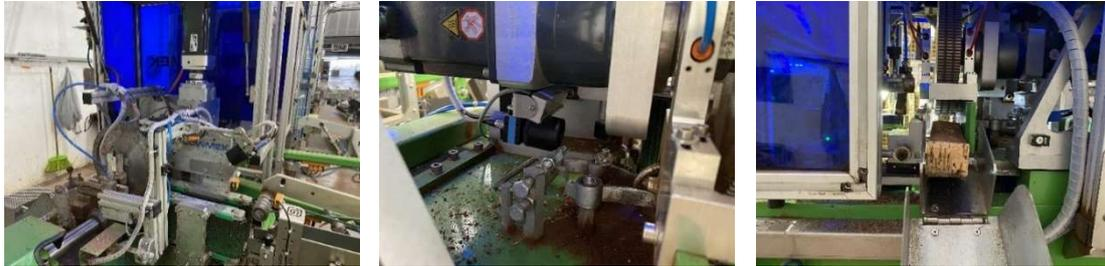
Figura 41 - Câmara de topo (1), câmara lateral (2) e broca (3)
