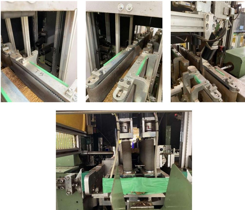
Figura 42 - Câmaras laterais (1 e 2), câmara de topo (3) e broca (4)
