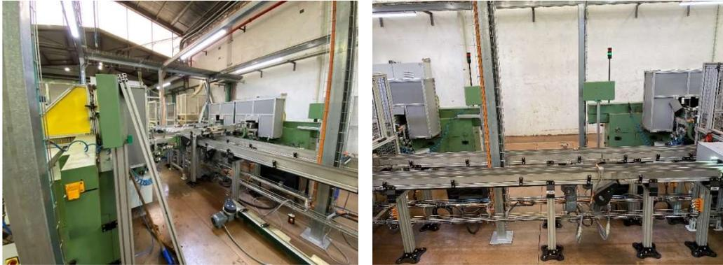
*Figura 107 - Ajuste das guias e eliminação dos "gaps" entre tapetes*
