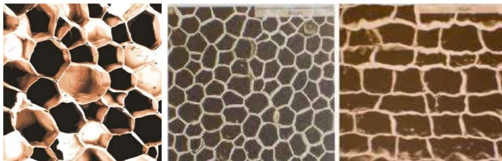
Figura 5 - Imagens de cortiça ao microscópio, evidenciando a sua estrutura alveolar
