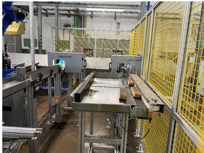
*Figura 38 - Mesas, canais de alimentação e sistema de rejeição de traços*
