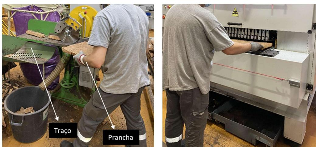
*Figura 20 - Rabaneação feita manualmente (à esquerda) e rabaneação automática nas rabaneadeiras (à direita)*
