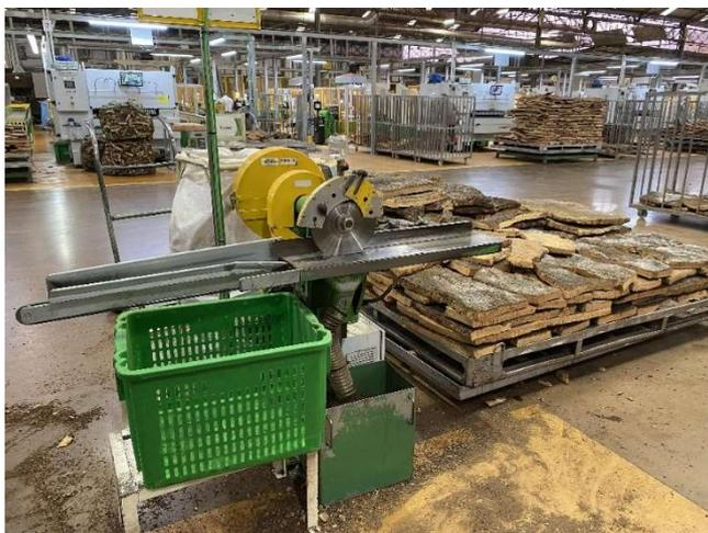
*Figura 24 - Apoio às brocas a pedal, constituído por uma rabaneadeira manual*
