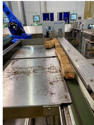
*Figura 67 - Encravamento na mesa devido a um traço a obstruir a calha*
