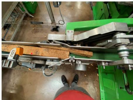
*Figura 65 - Encravamento de uma fita nos canais*
