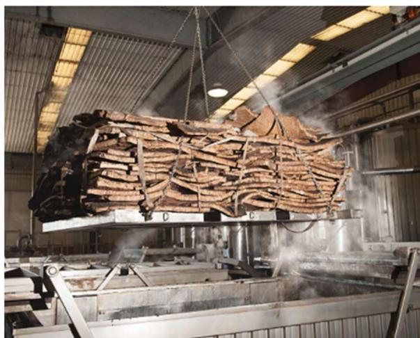
*Figura 13 - Tanques de cozedura*
