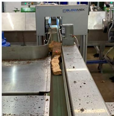
*Figura 68 - Encravamento na mesa devido a um bocado a obstruir a calha*
