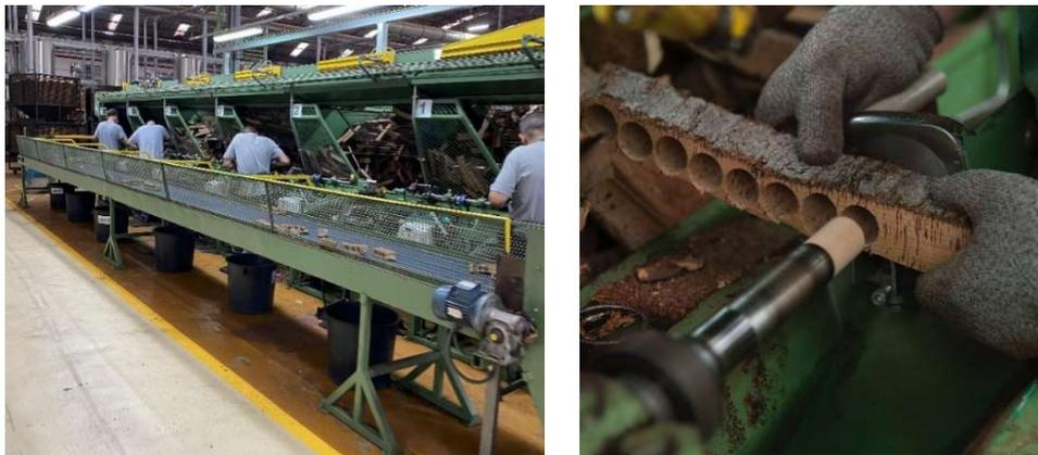
*Figura 28 - Linha de brocas manuais (à esquerda) e broquista a extrair uma rolha do traço (à direita)*
