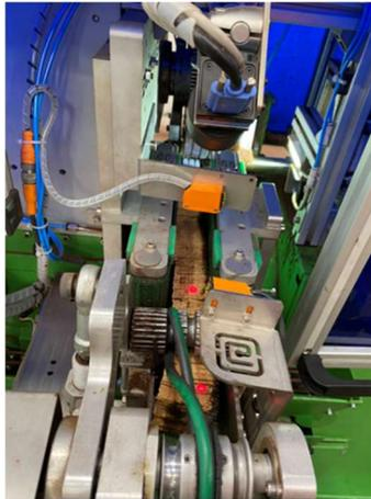
*Figura 60 - Paragem da broca devido a um traço de lado*
