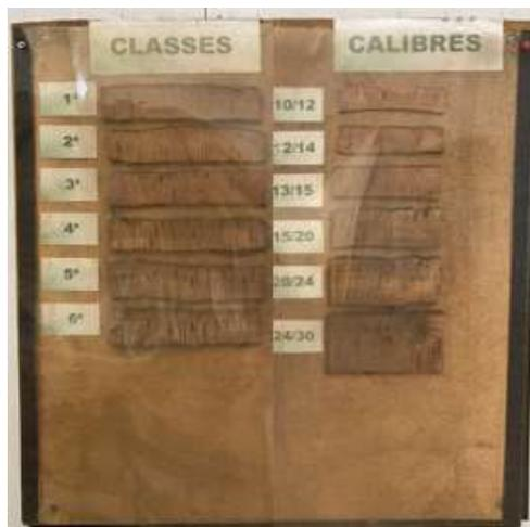
Figura 17 - Quadro com as classes e calibres das pranchas de cortiça
