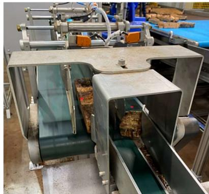
*Figura 70 - Encravamento nos desviadores devido a um bocado*
