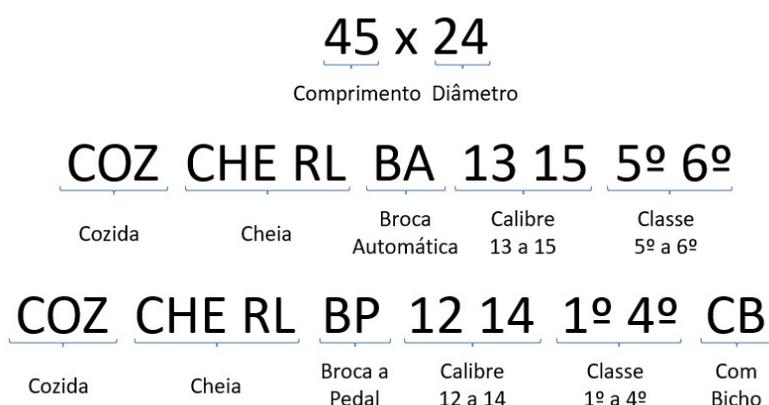
*Figura 9 - Exemplo de um calibre de rolha e de dois códigos respetivos a pranchas de cortiça*
