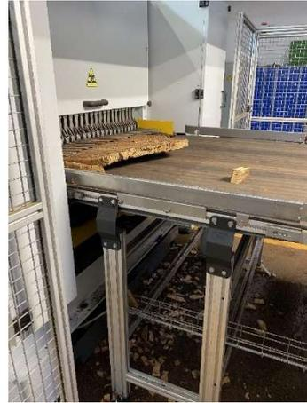
Figura 21 - Vista do outro lado da rabaneadeira automática, com as pranchas cortadas em traços
