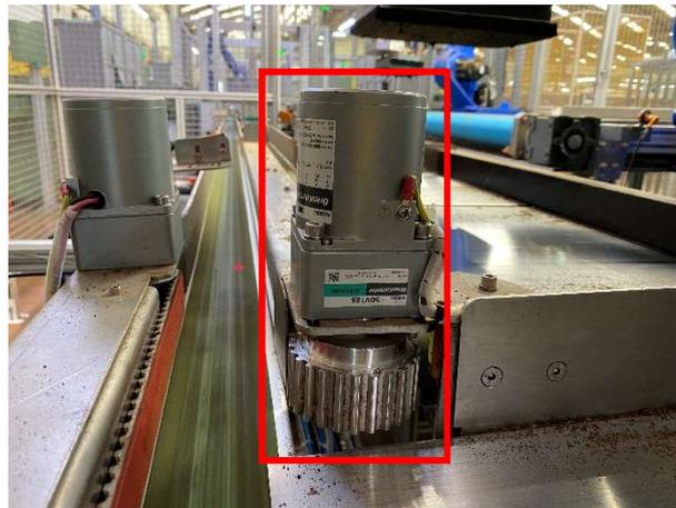
*Figura 105 - Instalação do motor responsável por girar a roldana*
