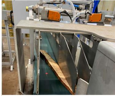
*Figura 71 - Encravamento nos desviadores devido a uma fita*
