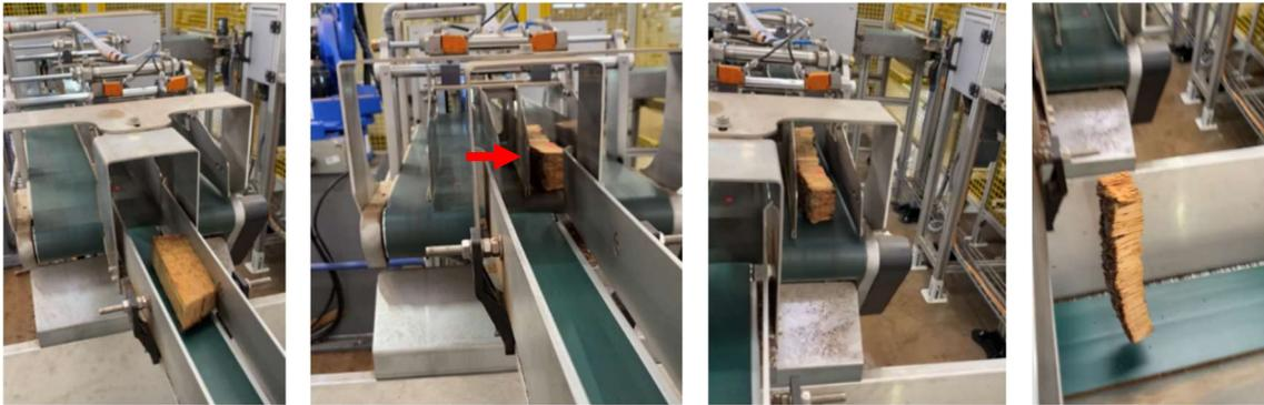
*Figura 57 - Funcionamento dos desviadores ao detetarem um traço de lado*
