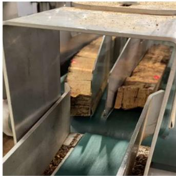
*Figura 69 - Encravamento nos desviadores devido a um traço de lado*
