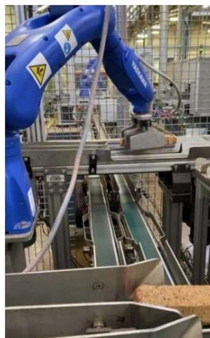
*Figura 34 - Robô das brocas com as pinças*
