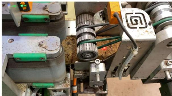
*Figura 63 - Encravamento de um traço na parte final do canal de alimentação*
