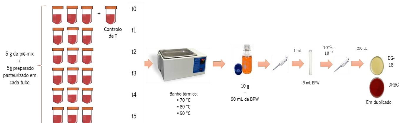
Figura 8. Esquema representativo da fase de pasteurização dos preparados de fruta.
