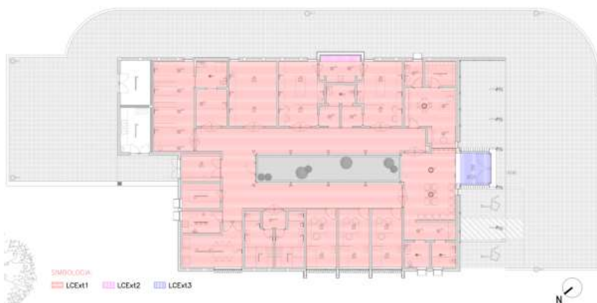
Figura 3.6. Planta com marcação da envolvente horizontal superior. (Fonte: Documento de trabalho adaptado do projeto de arquitetura)
