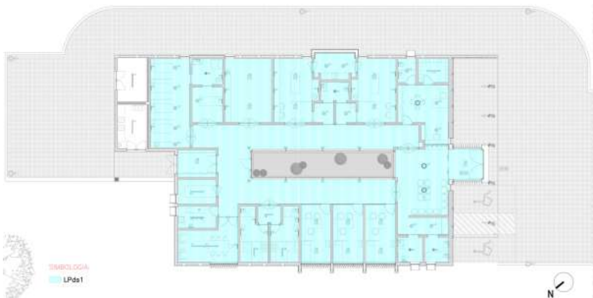
Figura 3.5. Planta com marcação da envolvente horizontal inferior. (Fonte: Documento de trabalho adaptado do projeto de arquitetura)
