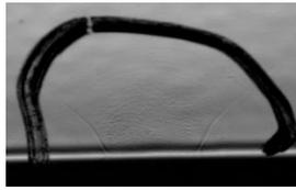
Figura 25- Amostra n°1 (Teste 1): detalhe da imagem após algoritmo de realce de contraste. Em foco os dois riscos a detetar.
