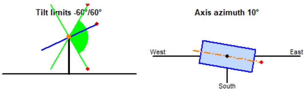
Figura 50 - Configuração do sistema seguidor de eixo horizontal no PVsyst.
