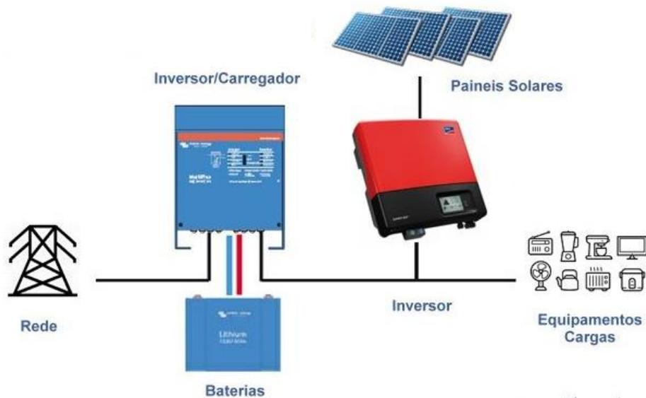
Figura 19 - Sistema fotovoltaico ligado à rede.
