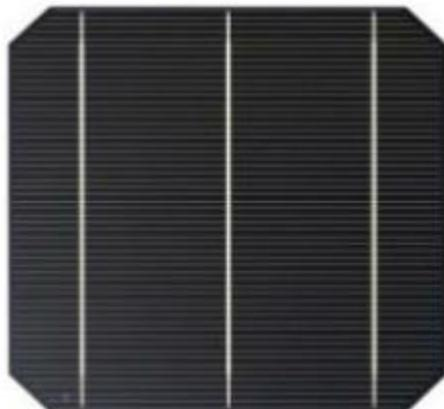
Figura 10 - Célula de silício monocristalino [18].
