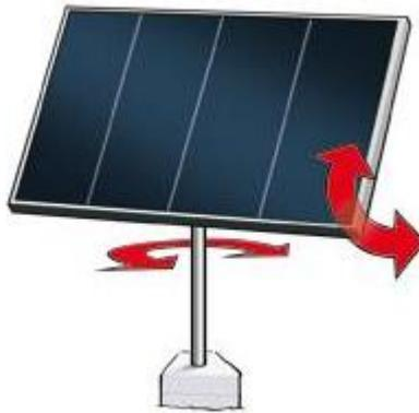
Figura 53 - Seguidor de 2 eixos [42].
