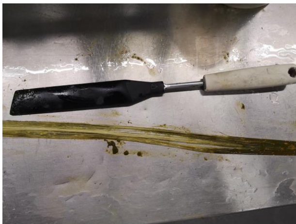
Figura 10: Método utilizado para a extração das fibras.
