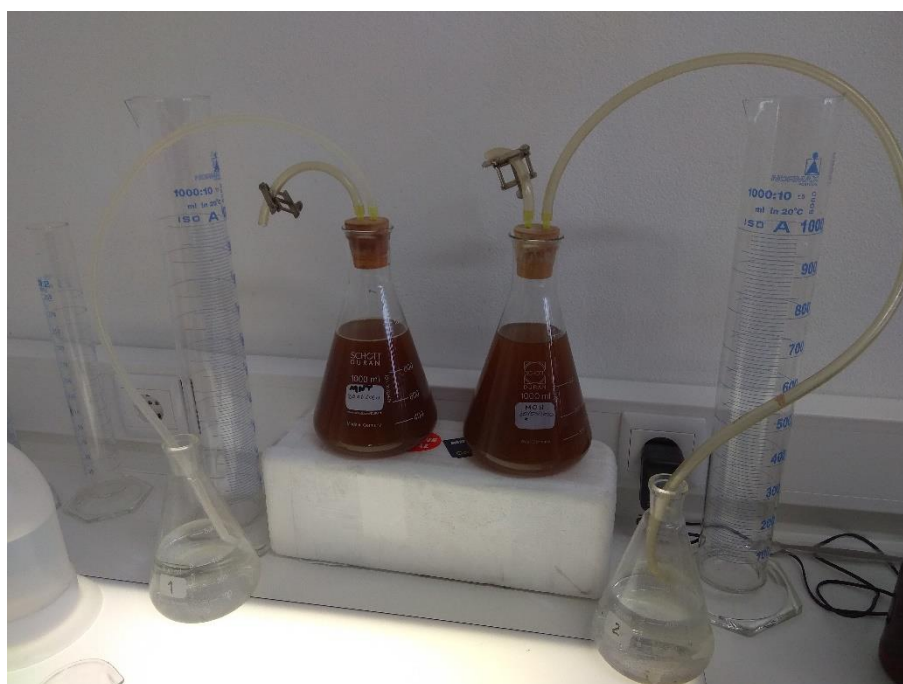
Figura 8. Instalação para acompanhamento da fermentação de dois mostos: à esquerda uma amostra de controlo e à direita uma amostra sujeita a tratamento Óhmico 1 .
