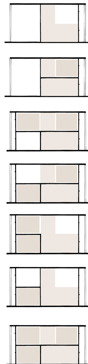
FIG.98. Variações da evolução espacial partindo do bloco servente, da forma mais simples à mais completa, em corte. Desenhos do autor.
