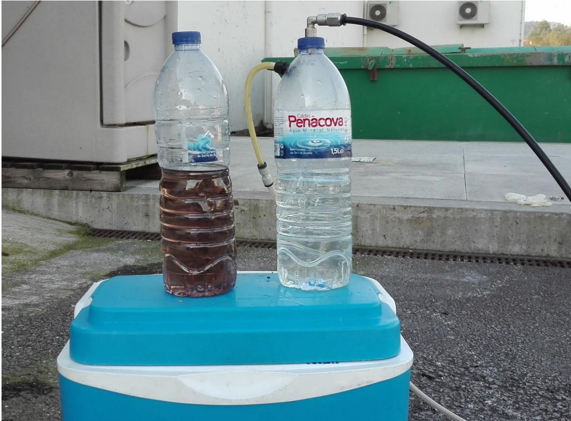
Figura 7: Sistema usado na ozonização das amostras de efluente final das diferentes ETARs, durante 1 min; Na esquerda uma amostra de água antes da ozonização e à direita uma amostra de água após a ozonização.
