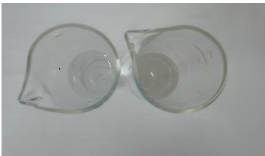
Figura 6 Análise visual da cor das diluições dos corantes, utilizando tubos de Nessler. À direita, tubo de Nessler com a solução de corante e à esquerda um tubo de Nessler contém água destilada.
