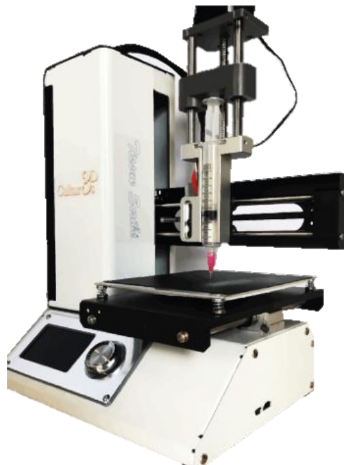
Figura 4.1 - Impressora 3D de soluções (adaptado de 3d cultures).
