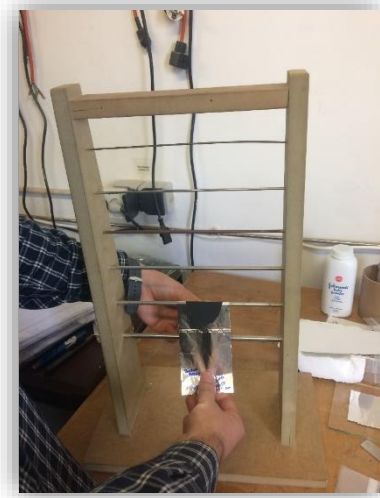
Figura 3.10 - Equipamento caseiro utilizado para o ensaio de "Bend test".
