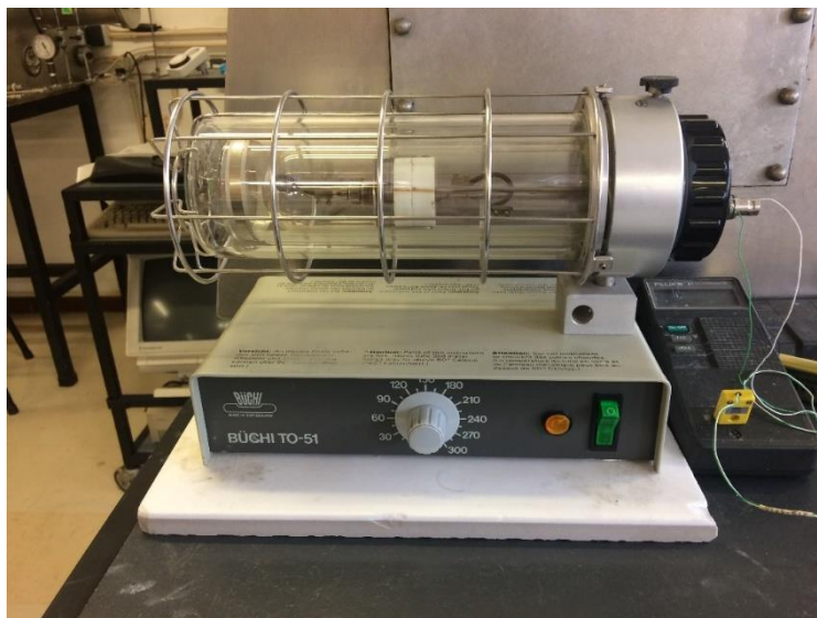
Figura 3.12 - Equipamento de Buchi utilizado nos ensaios de impedância.
