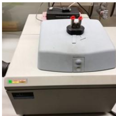
Figura 17 Diamond DSC , de compensação de potência, da Perkin Elmer com um controlador de temperatura ILP .
