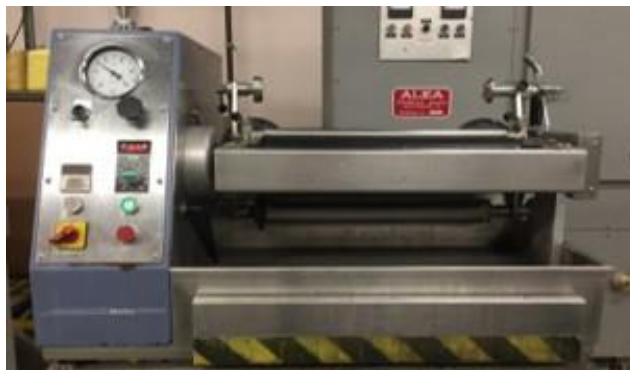
Figura 20 Equipamento denominado Foulard da Werner Mathis AG , onde foram realizados os ensaios de foulardagem para impregnação dos pigmentos termocrômicos no substrato de base têxtil, algodão cationizado.
