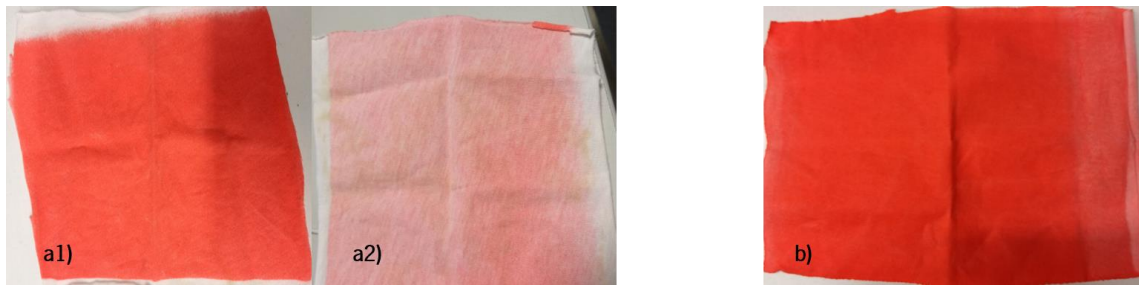
Figura 44 Resultados obtidos referentes à funcionalização dos provetes 100 % algodão recorrendo às técnicas de pulverização por pistola pressurizada e de revestimento por barra de Meyer; a1) frente sujeita à pulverização; a2) parte de trás do têxtil a1); b) têxtil colorido através da técnica revestimento por barra de Meyer.
