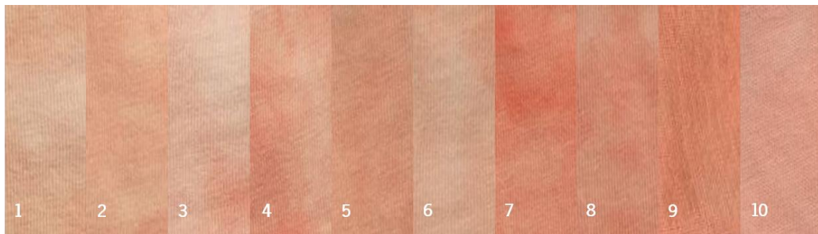
Figura 39 Resultados obtidos após funcionalização do substrato 100 % algodão cationizado, com alterações nas condições experimentais mostradas na tabela III da secção experimental 3.3.1. Os provetes estão numerados conforme o ensaio de 1 a 9.
