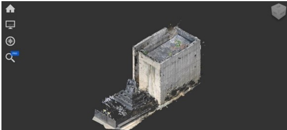
Figura 6 Nuvens de pontos unidas (registradas) no Autodesk ReCap. Fonte: os autores.
