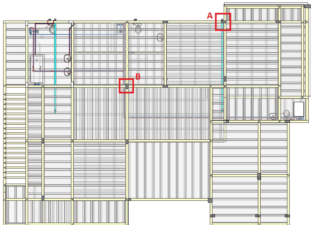
Figura 6 Identificação das incompatibilidades – Hidrossanitário x Estrutura.
