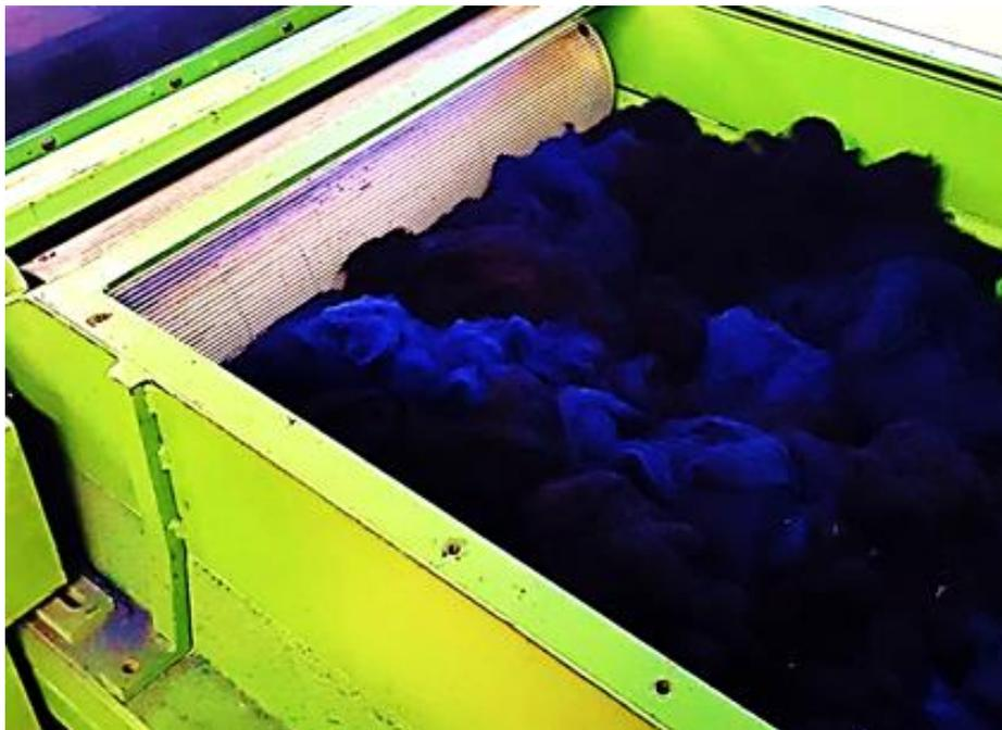
Figura 23: Disposição das Fibras para formação de véu colorido (Preto, Azul e Azul Escuro)
