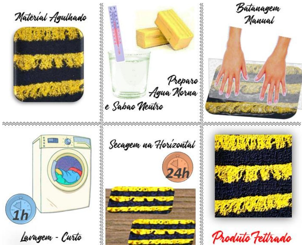
Figura 21: Resumo esquemático do Processo experimental de Feltragem Manual
