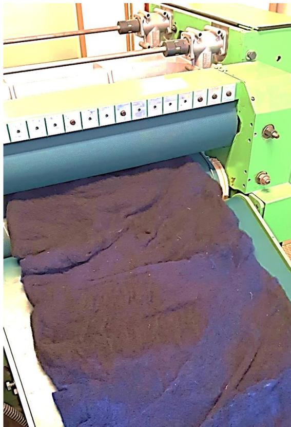
Figura 27: Posicionamento das peças na esteira intermediária para entrada na máquina de Agulhagem
