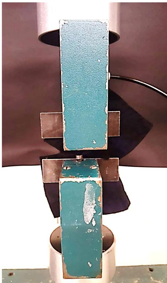
Figura 38: Presilhas adaptadas no dinamômetro modelo H100KS da Hounsfield para teste de rasgo
