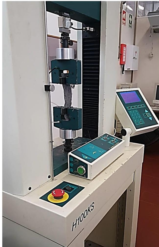
Figura 36: Dinamômetro modelo H100KS da *Hounsfield* preparado para teste de tração e alongamento
