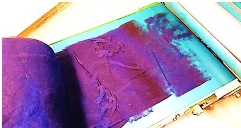
Figura 25: Véus sobrepostos na saída do dobrador horizontal
