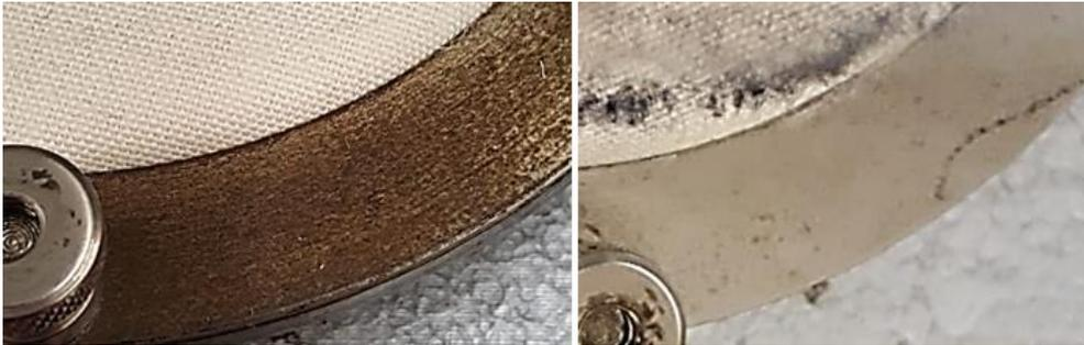
Figura 50: Acúmulo de pequenas fibras na matriz de contacto do teste de Abrasão - esquerda: matriz inicial, direita: matriz após a finalização do teste
